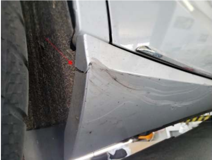
Schweller rechts (Riss/Bruch)
