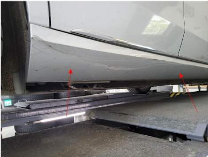
Schweller rechts (Riss/Bruch)
