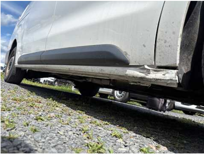
Schweller rechts (Verformung, Lackschaden, Kratzer)
