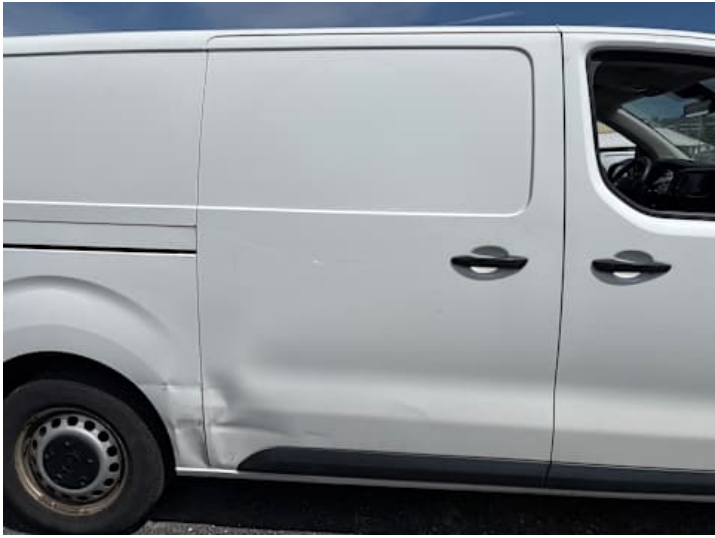
Türe hinten rechts (Delle, Verformung, Kratzer)
