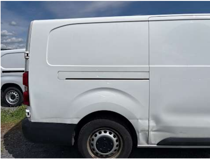
Seitenteil hinten rechts (Verformung, Kratzer, Delle)
