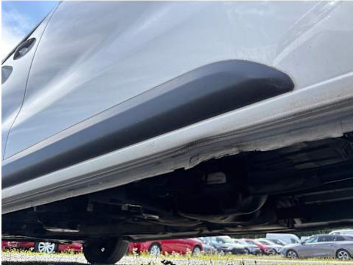
Schweller links (Verformung, Kratzer)
