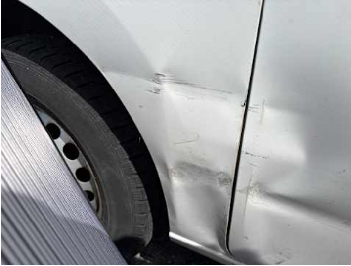
Seitenteil hinten rechts (Verformung, Kratzer, Delle)
