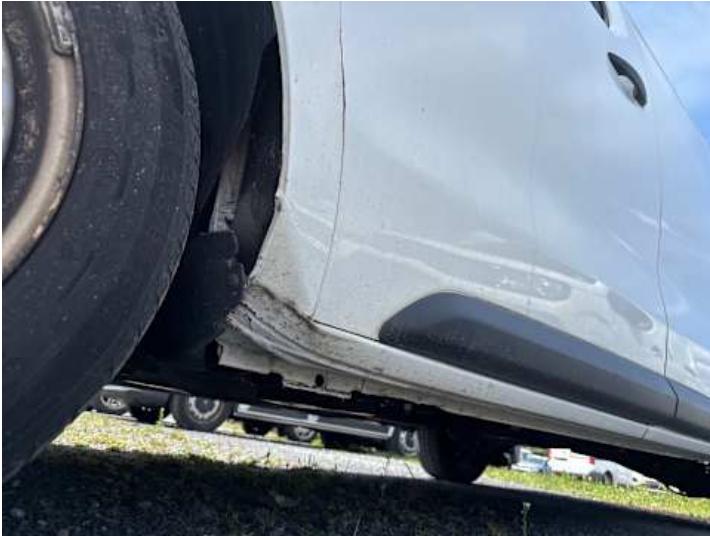
Schweller links (Verformung, Lackschaden)
