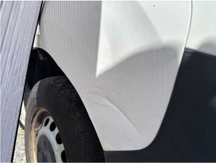
Kotflügel vorne rechts (Verformung, Kratzer, Delle)
