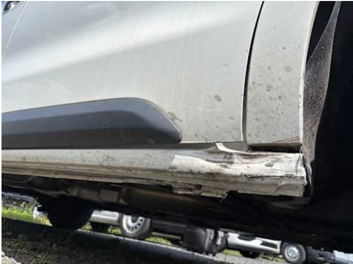
Schweller rechts (Verformung, Lackschaden, Kratzer)
