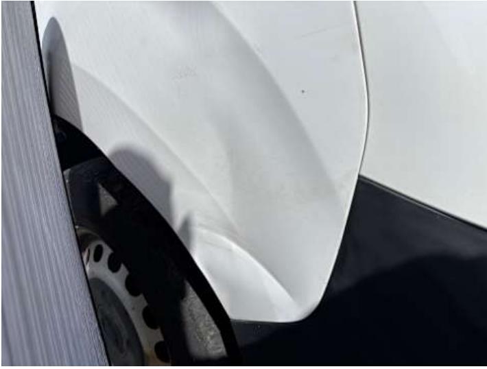
Kotflügel vorne rechts (Verformung, Kratzer, Delle)
