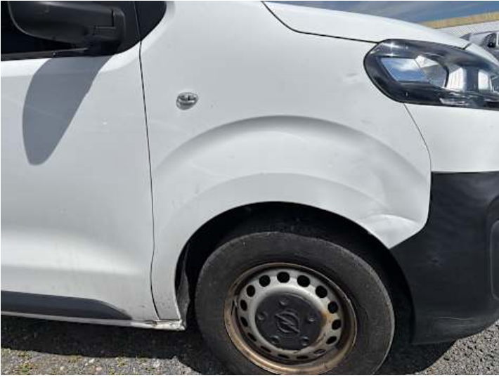
Kotflügel vorne rechts (Verformung, Kratzer, Delle)
