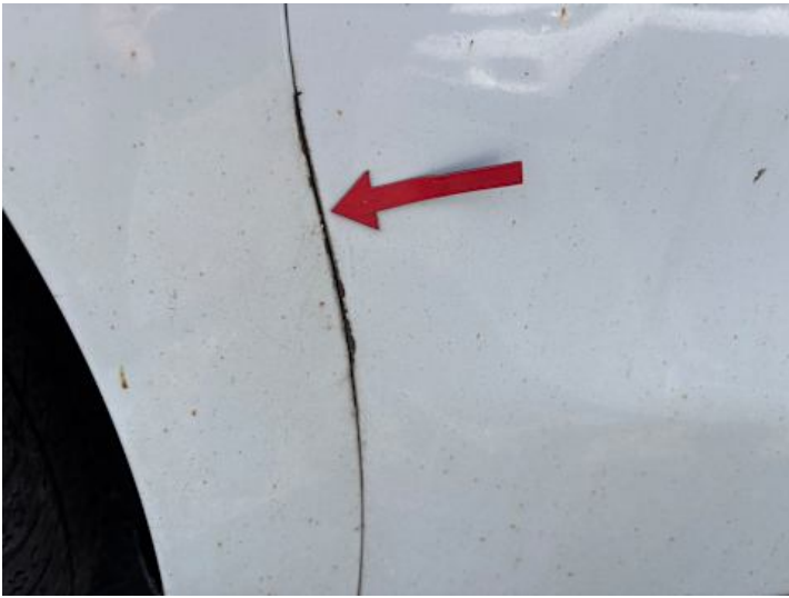
Fahrertür (Lackschaden, Rost, Spaltmaße ungenau)
