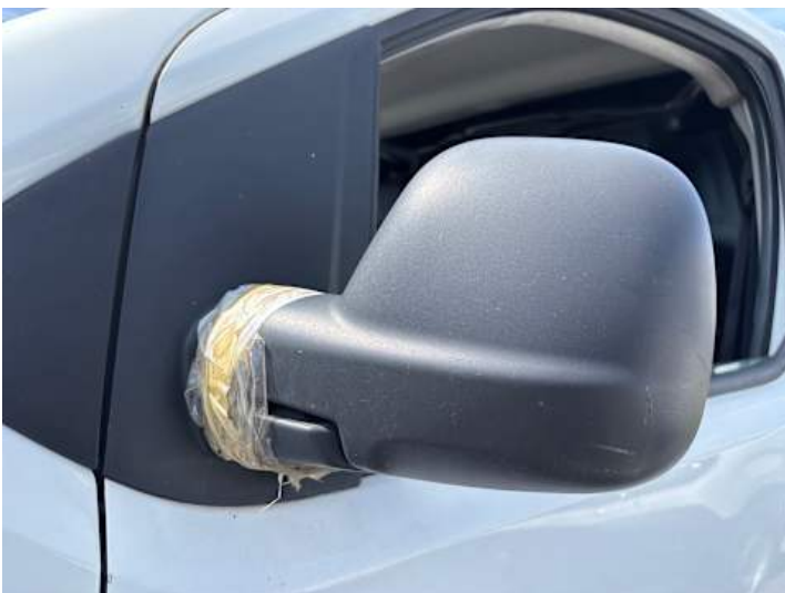
Fahrertür (Unsachgemäß instand gesetzt, Riss/Bruch)
