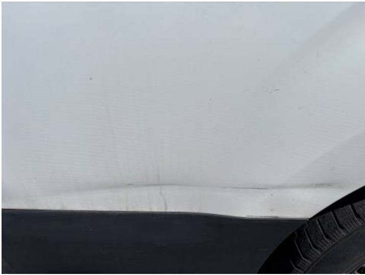
Seitenteil hinten rechts (Verformung, Kratzer, Delle)
