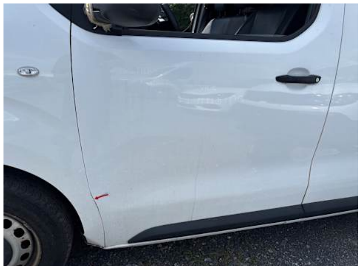
Fahrertür (Lackschaden, Rost, Spaltmaße ungenau)
