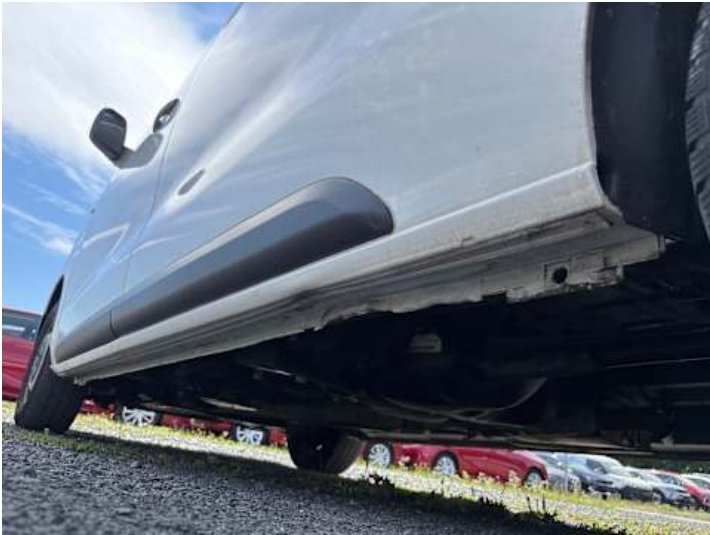
Schweller links (Verformung, Kratzer)
