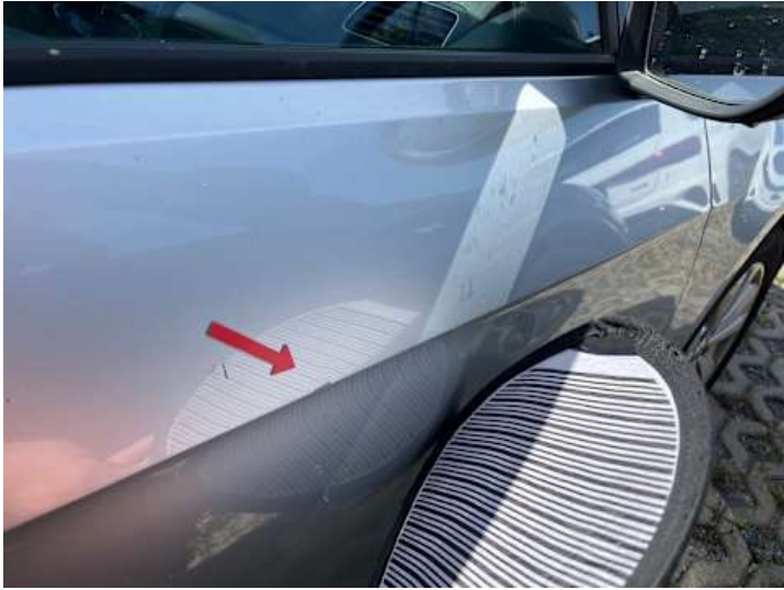
Beifahrtür (Kratzer, Delle)
