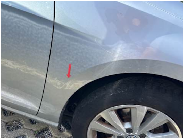
Kotflügel vorne rechts (Delle)
