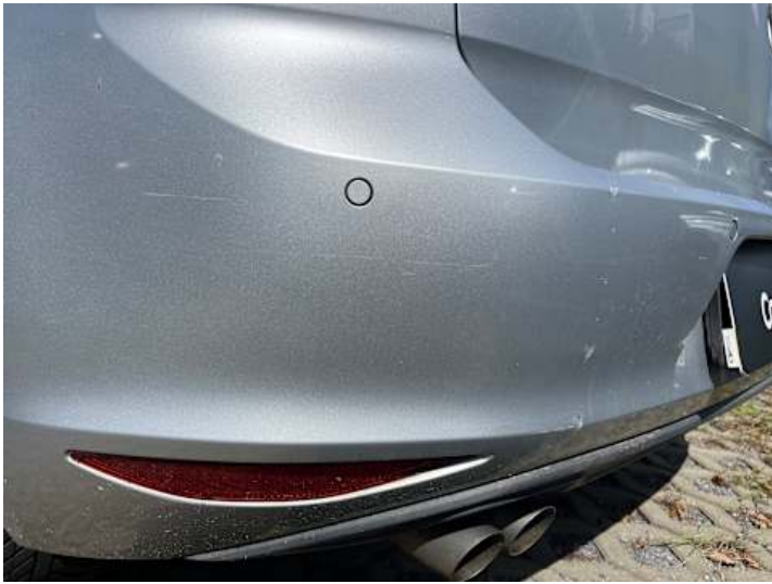
Stoßstange hinten (Kratzer)
