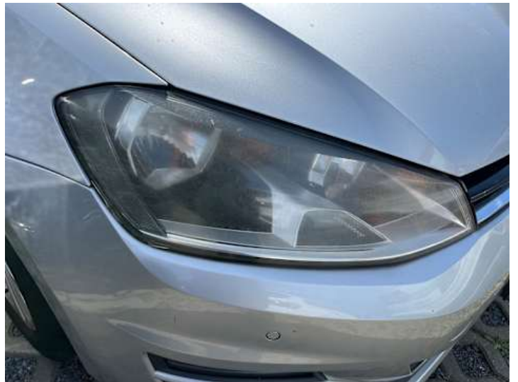
Scheinwerfer (rechts) (Blind, Riss/Bruch)
