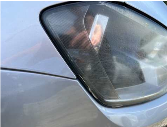
Scheinwerfer (rechts) (Blind, Riss/Bruch)
