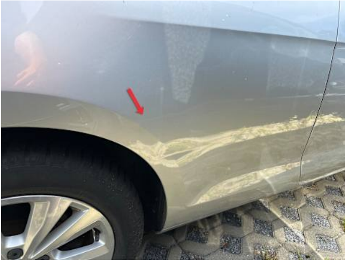
Seitenteil hinten rechts (Delle, Kratzer)
