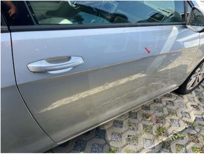
Beifahrtür (Kratzer, Delle)
