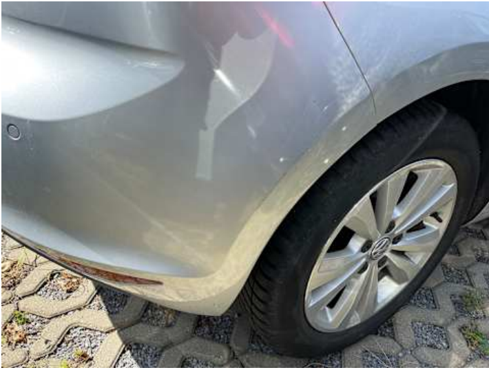
Stoßstange hinten (Kratzer)
