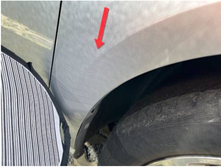
Kotflügel vorne rechts (Delle)
