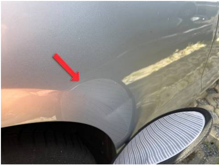
Seitenteil hinten rechts (Delle, Kratzer)
