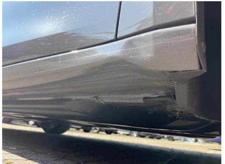
Schweller rechts (Verformung)
