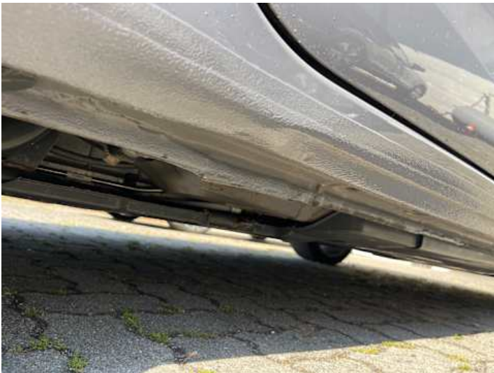
Schweller rechts (Verformung)
