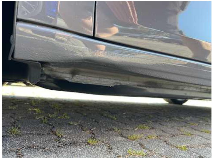
Schweller links (Verformung)
