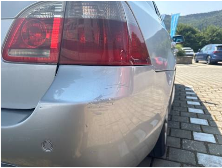
Stoßstange hinten (Lackschaden, Kratzer, Unsachgemäß instand gesetzt)
