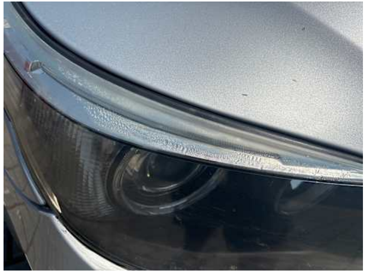
Scheinwerfer (rechts) (Undicht)
