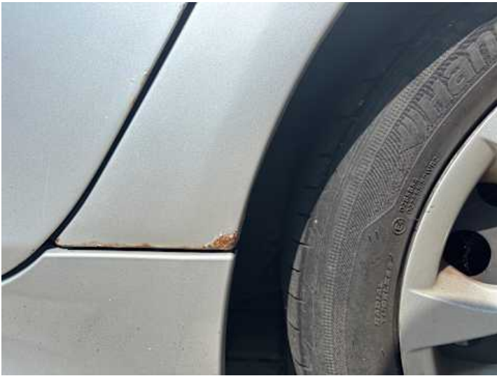
Seitenteil hinten links (Lackschaden, Rost)
