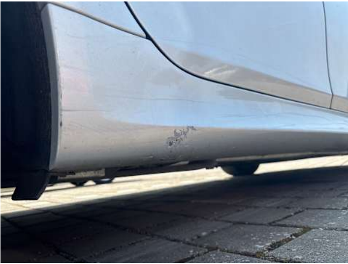
Schweller rechts (Lackschaden, Kratzer)
