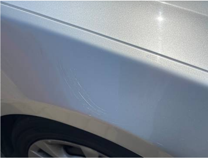
Kotflügel vorne rechts (Lackschaden, Kratzer)
