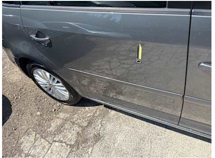
Türe hinten rechts (Kratzer, Lackschaden, Delle)
