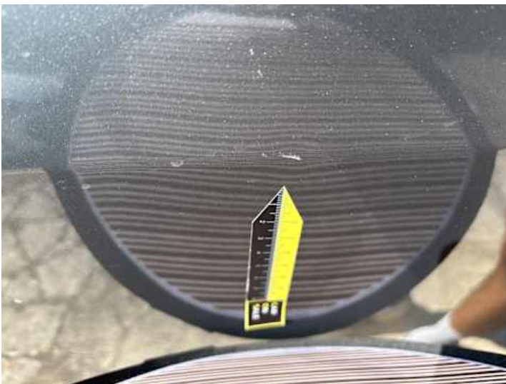
Türe hinten rechts (Kratzer, Lackschaden, Delle)
