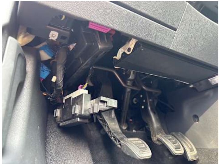
Innenraum (Anderer Schaden, Riss/Bruch): Kabel lose
