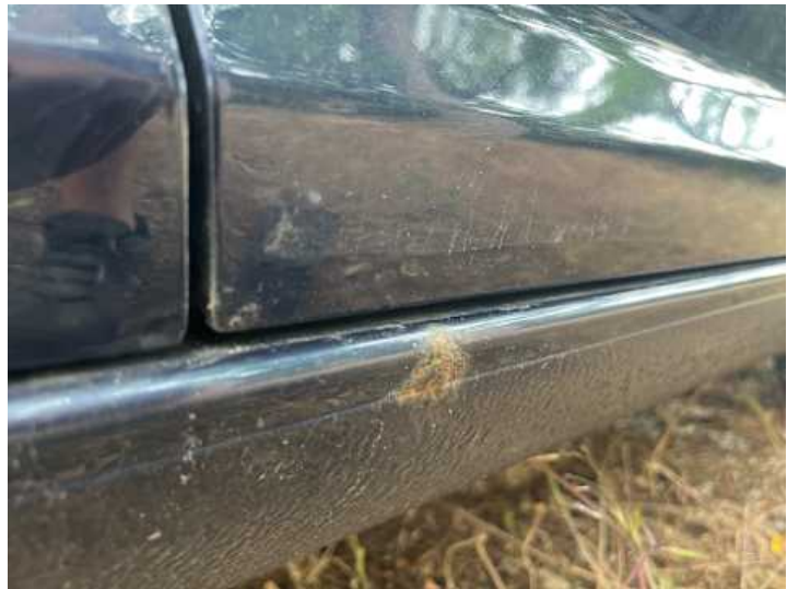
Türe hinten links (Rost)
