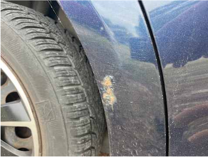
Seitenteil hinten rechts (Rost)
