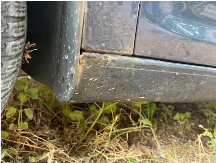
Schweller links (Rost)
