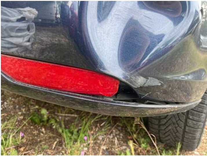
Rücklicht (rechts) (Riss/Bruch)
