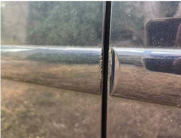
Fahrtür (Lackschaden, Kratzer)
