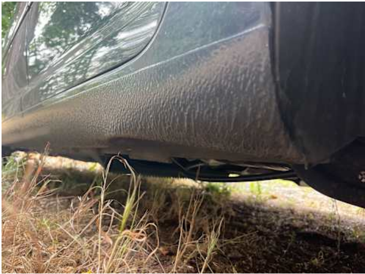
Schweller links (Verformung)
