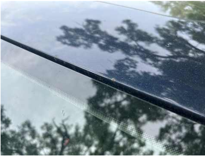
Dach (Lackschaden, Steinschlag, Rost)
