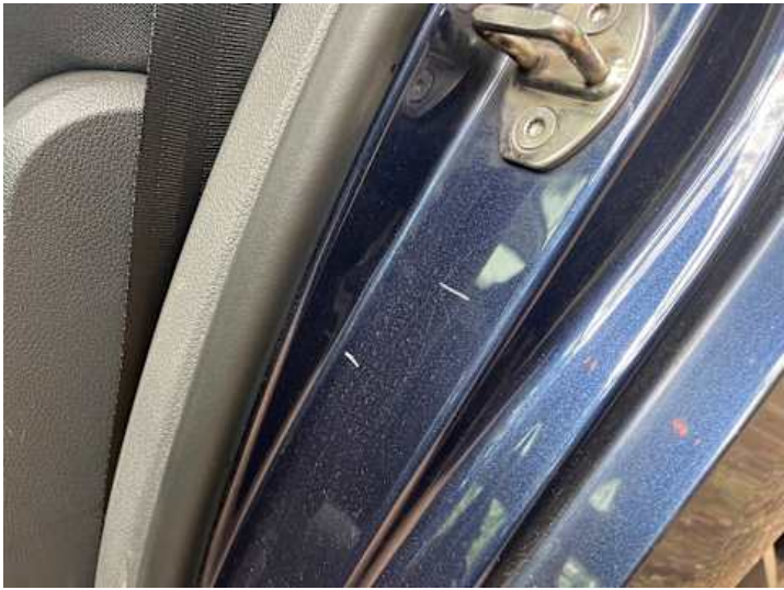
Seitenteil hinten links (Lackschaden, Kratzer)
