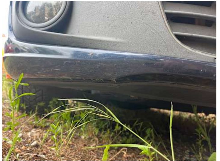
Stoßstange vorne (Lackschaden, Kratzer)
