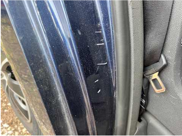
Seitenteil hinten rechts (Lackschaden, Kratzer)
