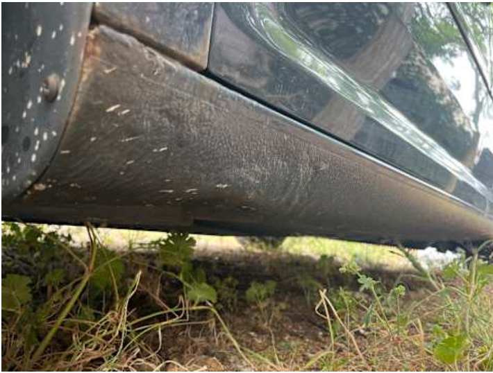
Schweller links (Verformung)
