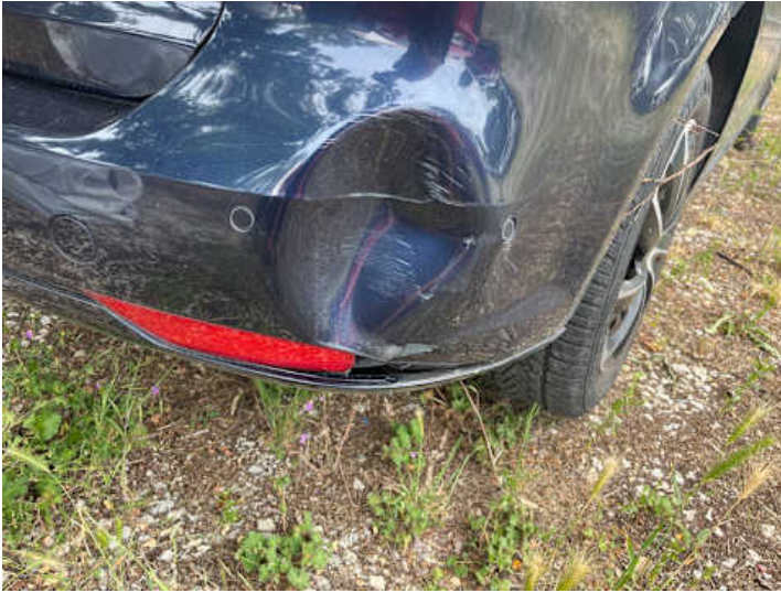
Stoßstange hinten (Lackschaden, Kratzer, Verformung, Riss/Bruch)
