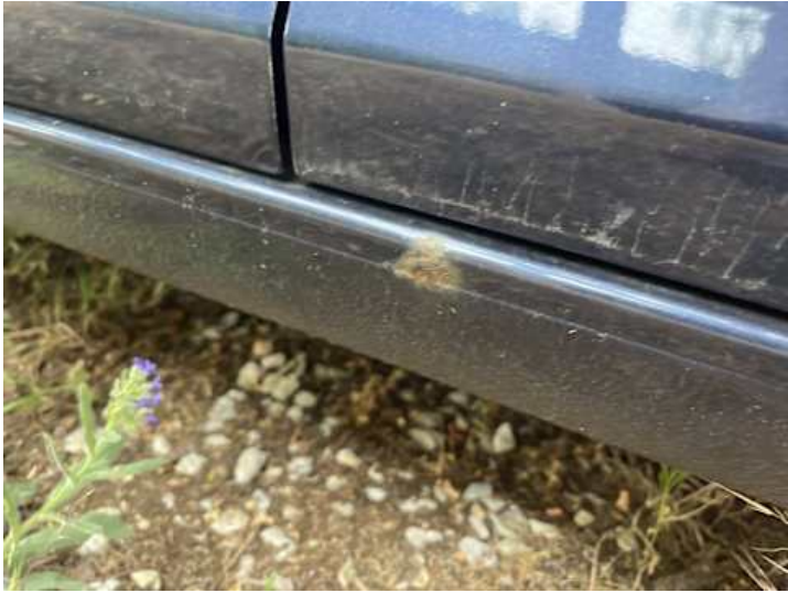
Schweller links (Rost)
