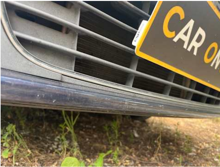
Stoßstange vorne (Lackschaden, Kratzer)
