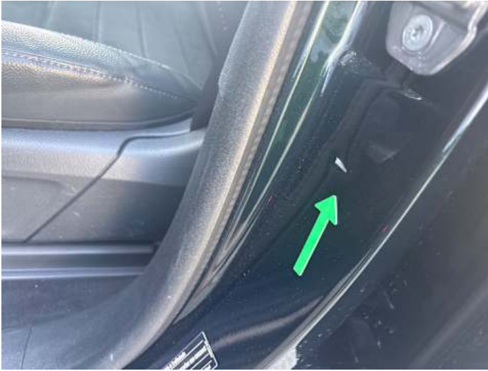
Schweller links (Kratzer, Delle)
