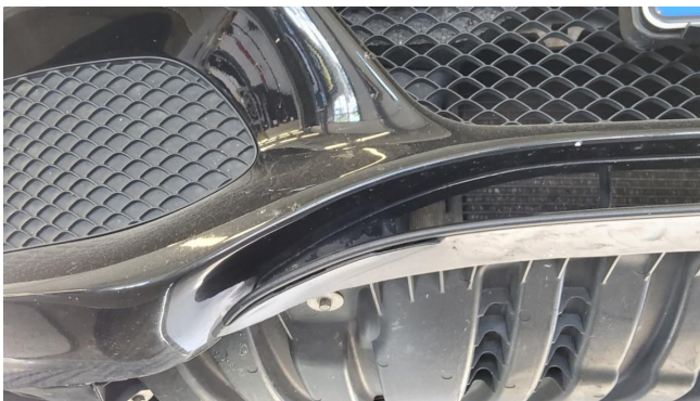
Spoiler vorne unten, beschädigt, erneuern
