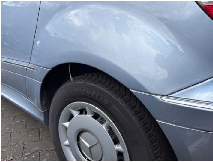
Seitenteil hinten links (Lackschaden, Rost, Kratzer)
