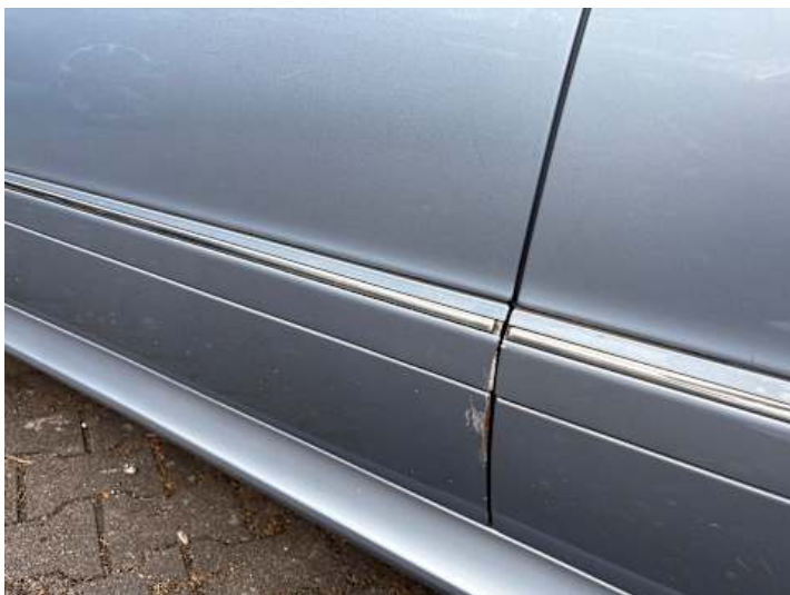
Fahrtür (Kratzer, Rost)
