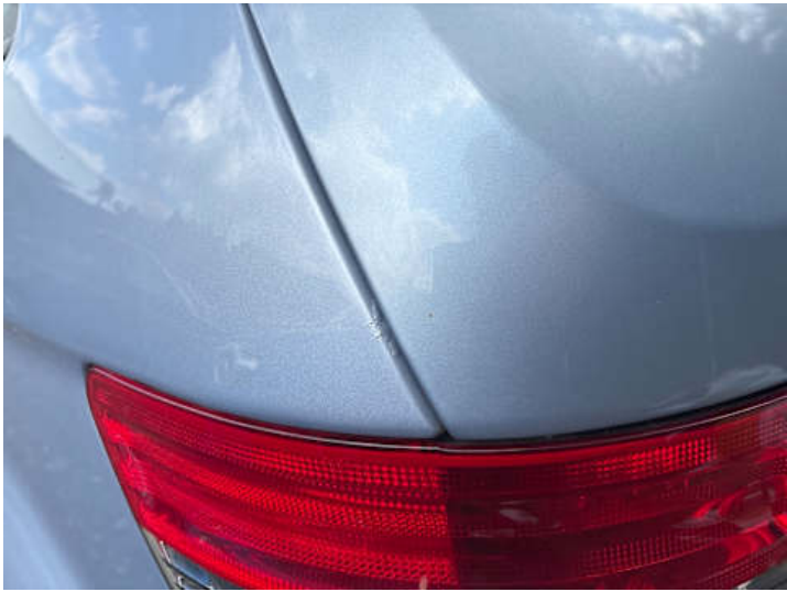
Seitenteil hinten links (Lackschaden, Rost, Kratzer)
