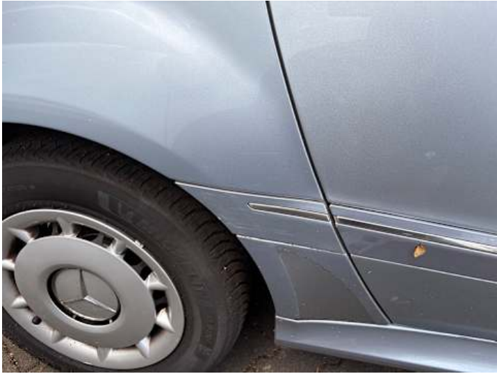
Seitenteil hinten rechts (Kratzer, Delle)
