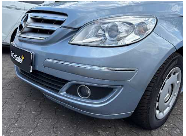
Stoßstange vorne (Kratzer, Lackschaden, Spaltmaße ungenau)
