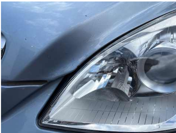
Motorhaube (Delle, Steinschlag)
