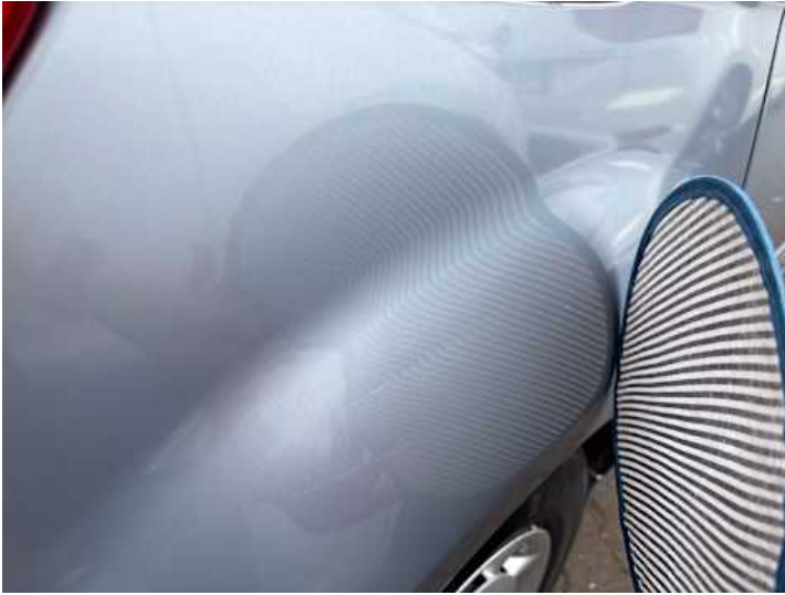
Seitenteil hinten rechts (Kratzer, Delle)
