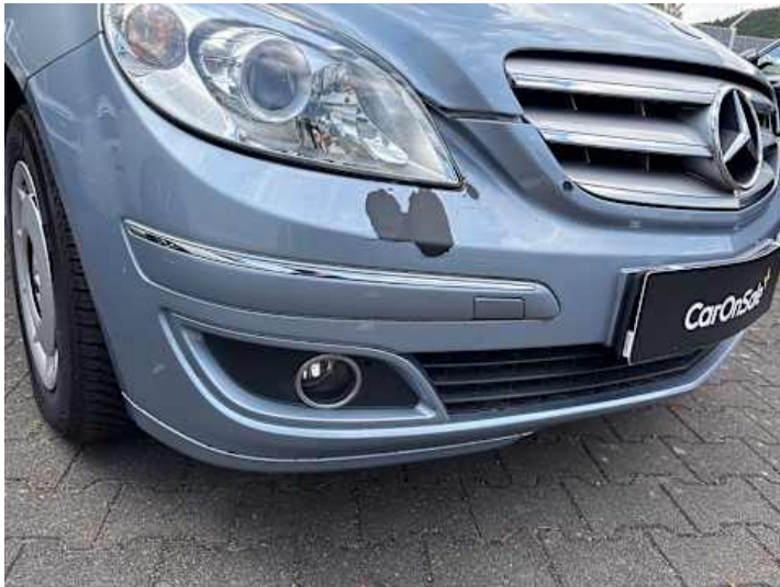
Stoßstange vorne (Kratzer, Lackschaden, Spaltmaße ungenau)
