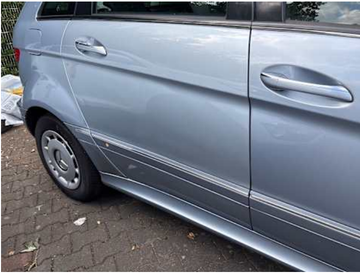
Türe hinten rechts (Lackschaden)
