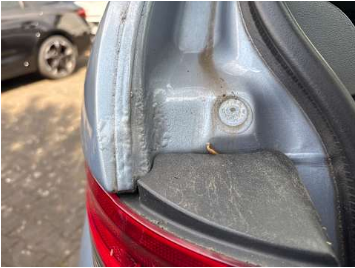
Seitenteil hinten links (Lackschaden, Rost, Kratzer)
