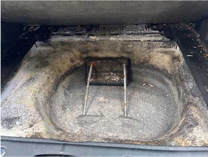
Innenraum (Verschmutzung, Anderer Schaden): Schimmelbefall Kofferraumboden
