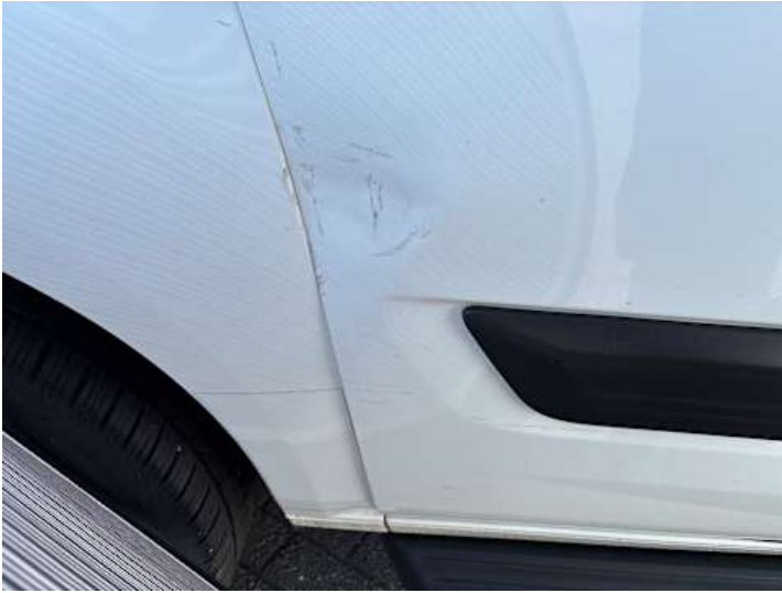
Türe hinten rechts (Kratzer, Verformung)
