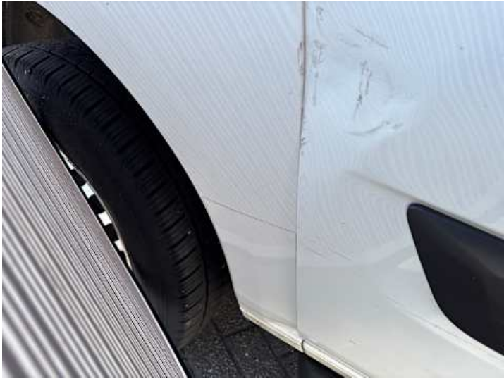
Seitenteil hinten rechts (Verformung, Kratzer)
