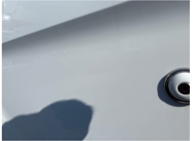
Fahrertür (Kratzer, Delle)
