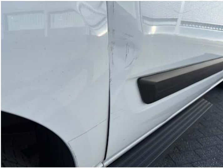
Türe hinten rechts (Kratzer, Verformung)
