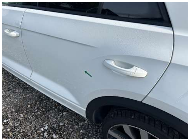
Türe hinten links (Delle, Kratzer)
