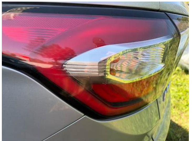
Rücklicht (links) (Kratzer, Riss/Bruch)
