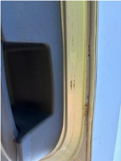
Heckklappe (Rost, Lackschaden)
