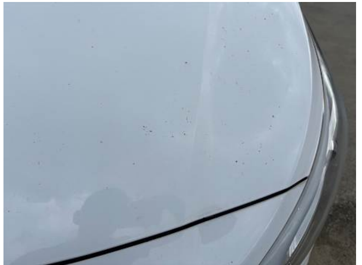
Motorhaube (Steinschlag, Lackschaden)
