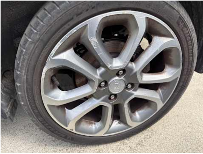
Rad (Kerben, Kratzer, Rost)
