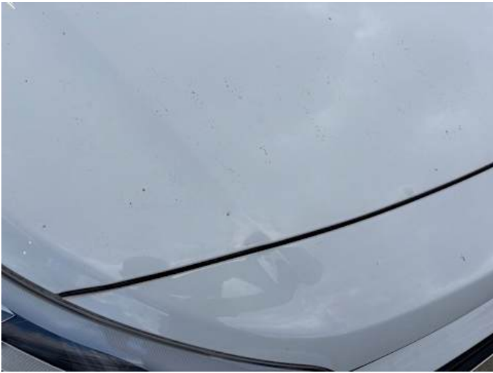
Motorhaube (Steinschlag, Lackschaden)
