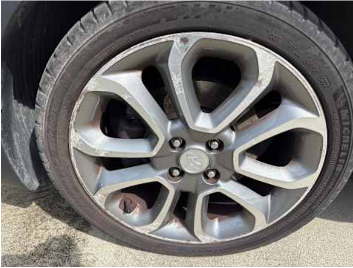
Rad (Kerben, Kratzer, Rost)
