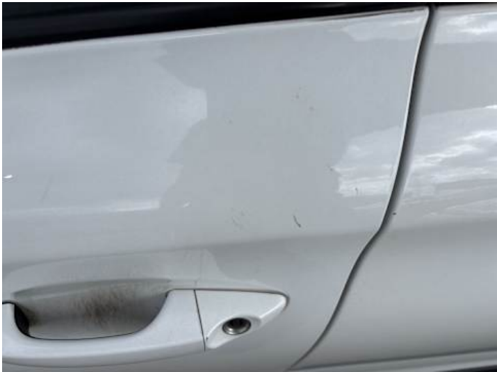
Fahrtür (Delle, Kratzer)
