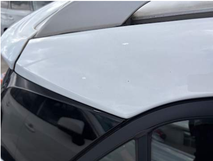
Seitenteil hinten rechts (Kratzer)
