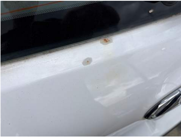
Heckklappe (Lackschaden, Kratzer, Rost)
