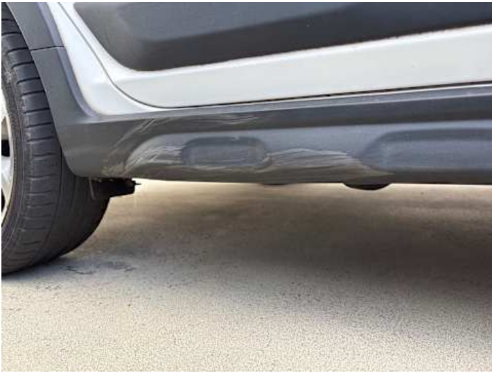
Schweller rechts (Kratzer)
