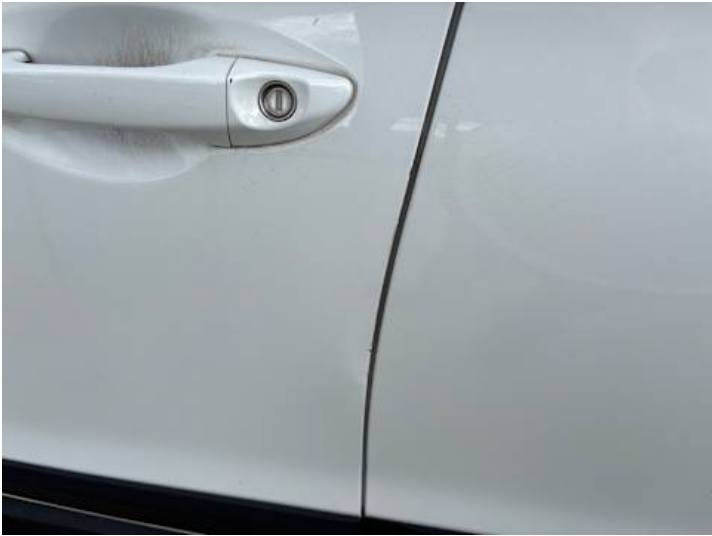
Fahrtür (Delle, Kratzer)
