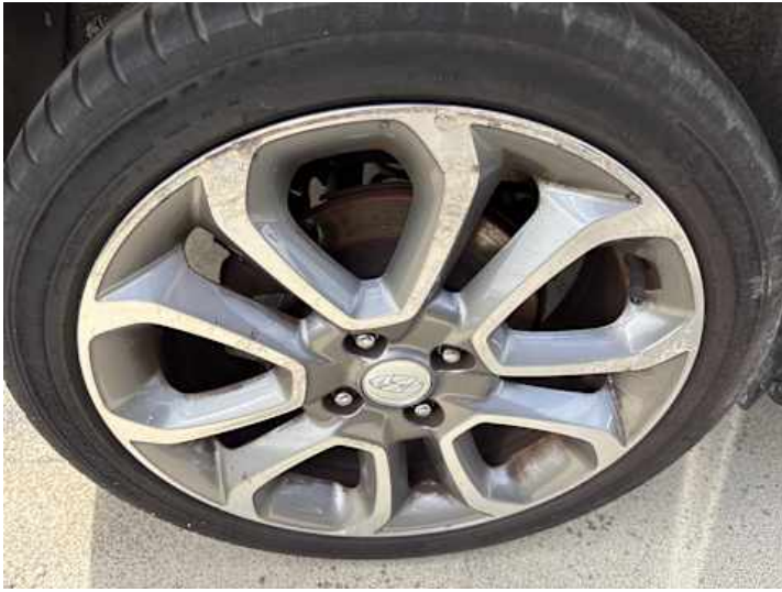
Rad (Kerben, Kratzer, Rost)
