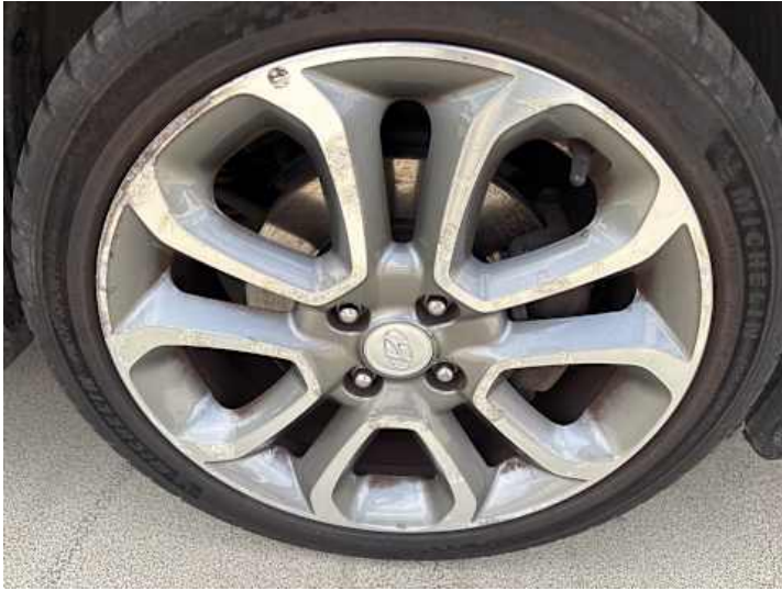
Rad (Kerben, Kratzer, Rost)
