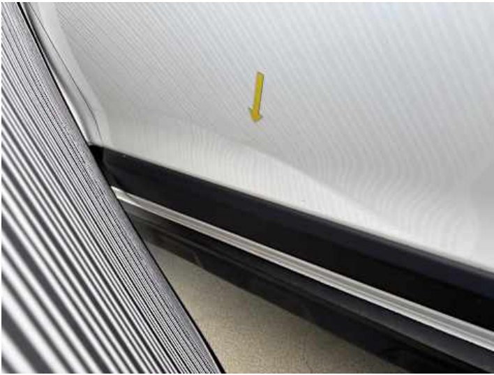
Beifahrertür (Kratzer, Verformung)
