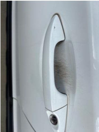
Fahrtür (Delle, Kratzer)
