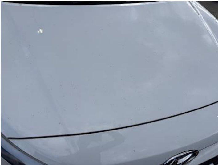
Motorhaube (Steinschlag, Lackschaden)
