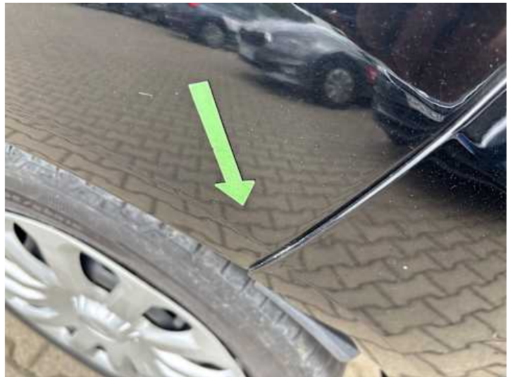
Seitenteil hinten links (Spaltmaße ungenau)
