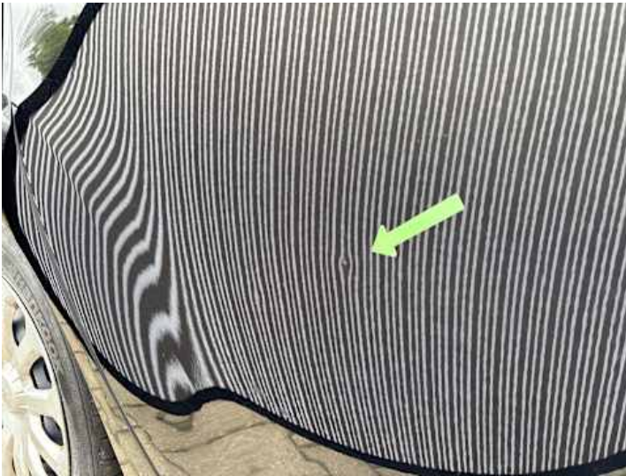
Türe hinten rechts (Delle, Lackschaden)
