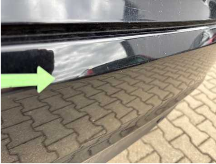
Stoßstange hinten (Kratzer, Lackschaden)
