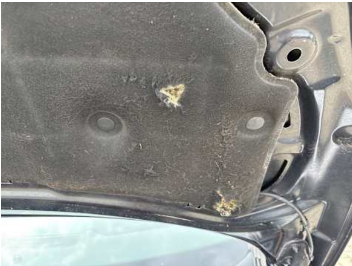
Motorhaube (Anderer Schaden): Dämmmatte beschädigt
