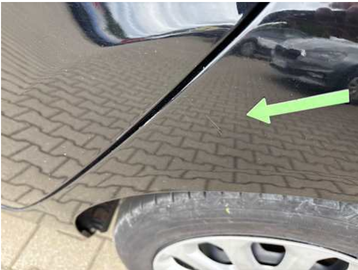
Seitenteil hinten links (Kratzer, Lackschaden)
