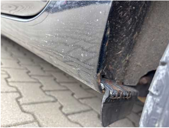
Schweller links (Rost)
