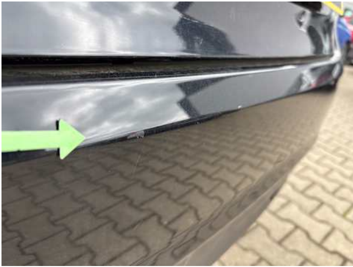
Stoßstange hinten (Kratzer, Lackschaden)
