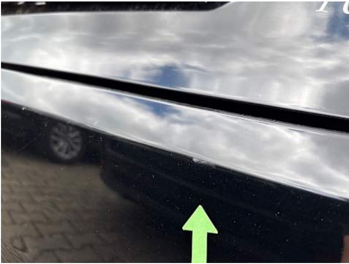
Stoßstange hinten (Kratzer, Lackschaden)
