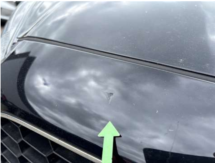
Stoßstange vorne (Lackschaden, Delle)
