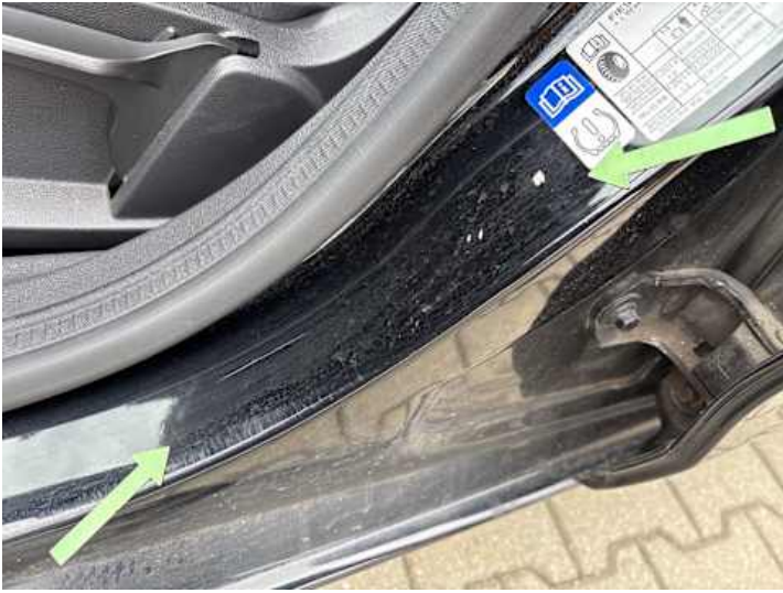
Schweller links (Kratzer, Lackschaden)
