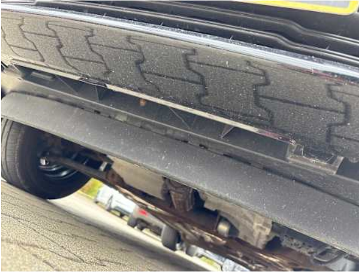
Stoßstange vorne (Anderer Schaden): Spoilerlippe lose
