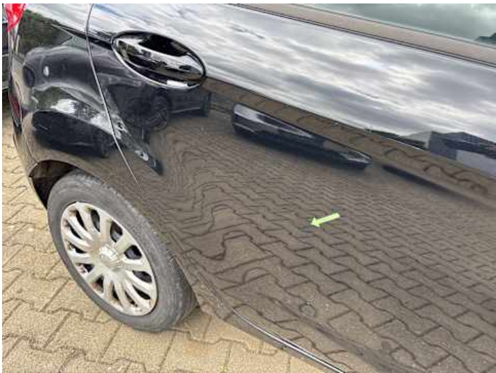
Türe hinten rechts (Delle, Lackschaden)
