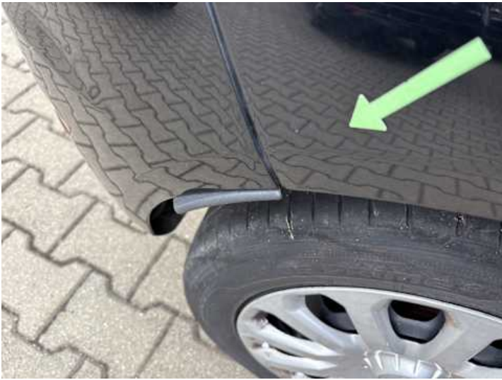
Seitenteil hinten rechts (Spaltmaße ungenau)
