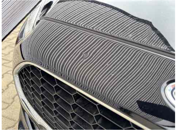
Stoßstange vorne (Lackschaden, Delle)
