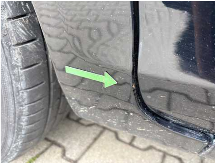
Kotflügel vorne links (Rost)
