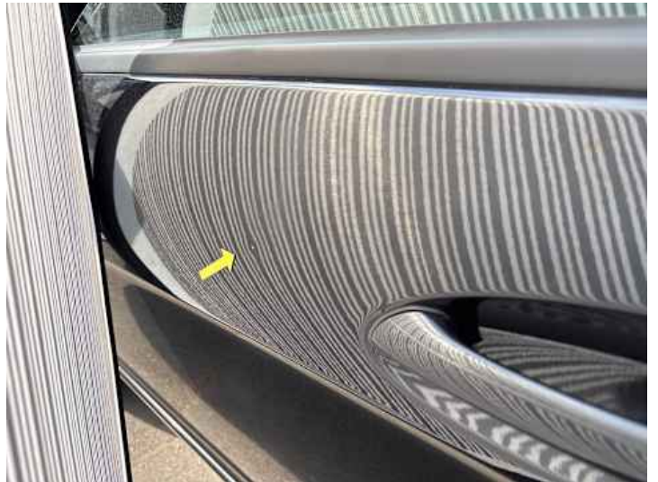
Fahrtür (Delle, Kratzer)
