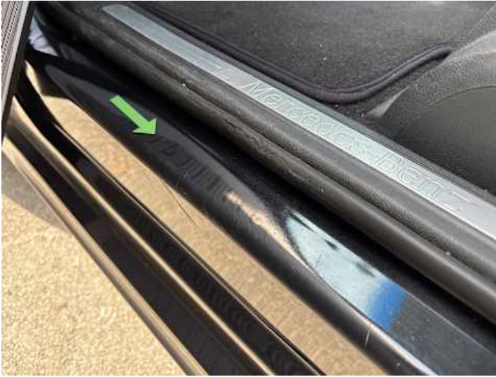
Schweller links (Kratzer, Delle)
