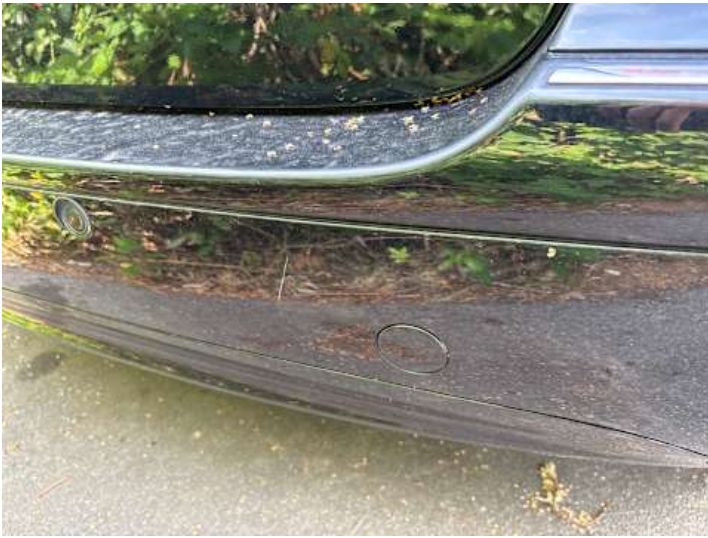
Stoßstange hinten (Spaltmaße ungenau, Kratzer)
