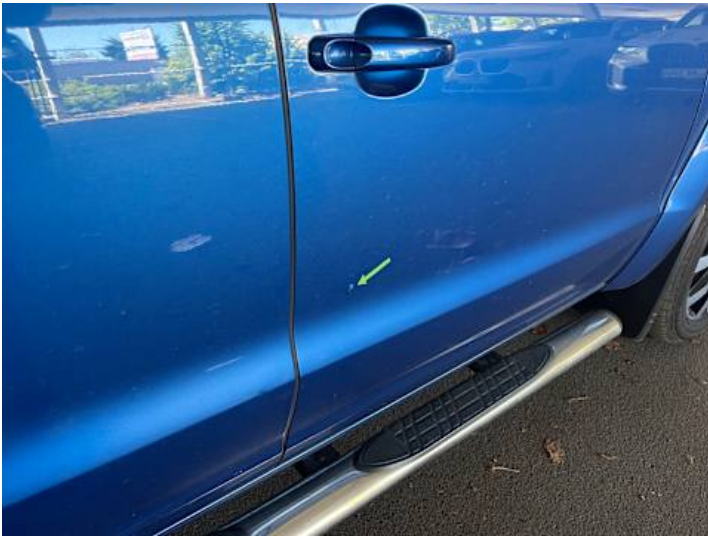
Beifahrertür (Lackschaden, Rost)
