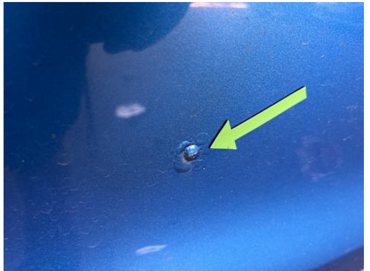
Beifahrertür (Lackschaden, Rost)
