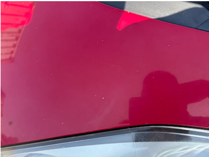
Motorhaube (Ausgeblichen/Matt, Steinschlag)
