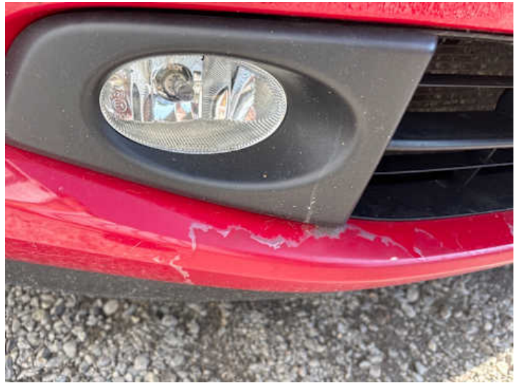
Stoßstange vorne (Lackschaden, Unsachgemäß instand gesetzt)
