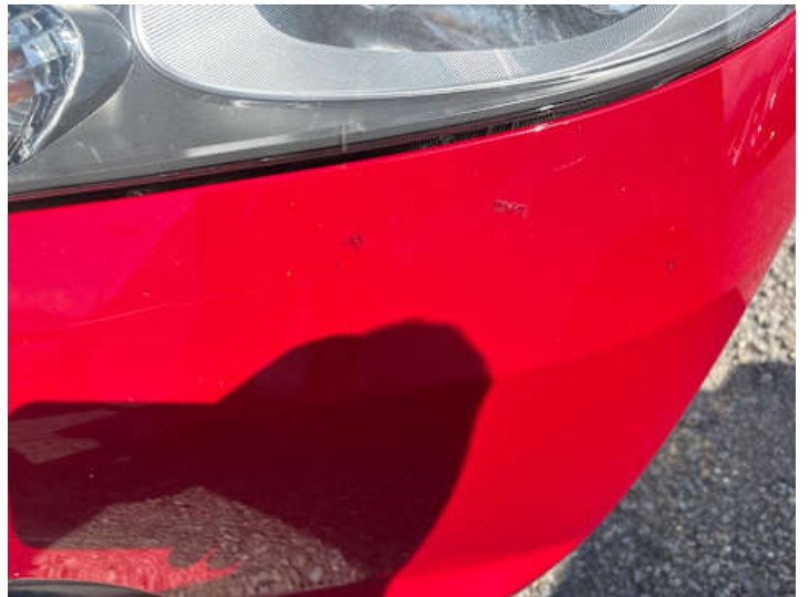
Stoßstange vorne (Lackschaden, Unsachgemäß instand gesetzt)
