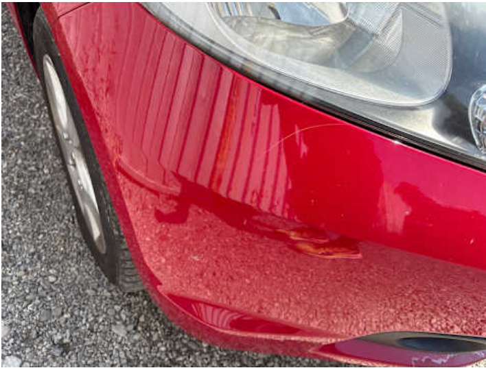
Stoßstange vorne (Lackschaden, Unsachgemäß instand gesetzt)
