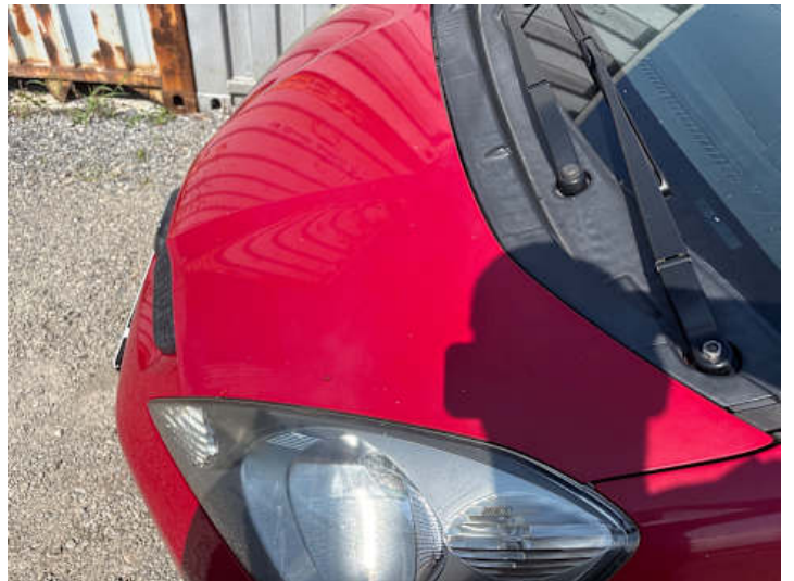
Motorhaube (Ausgeblichen/Matt, Steinschlag)
