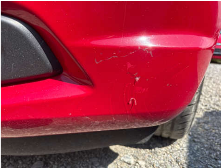
Stoßstange vorne (Lackschaden, Unsachgemäß instand gesetzt)
