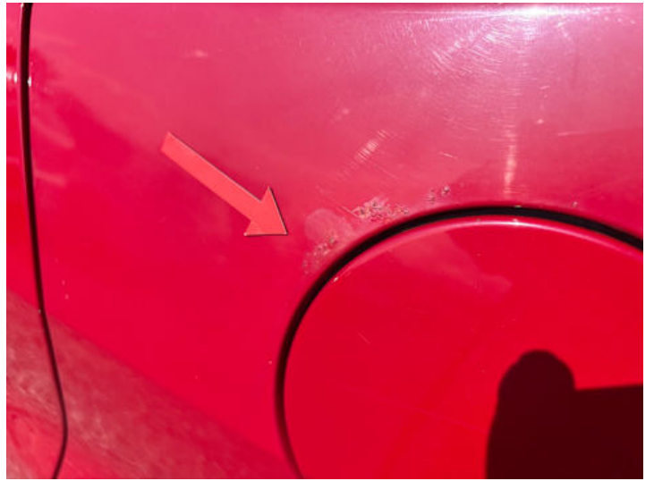
Seitenteil hinten links (Delle, Rost)
