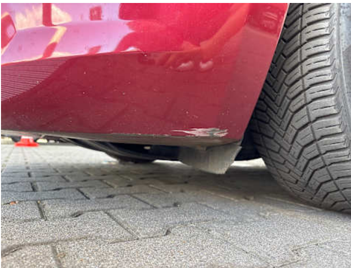
Stoßstange vorne (Kratzer)
