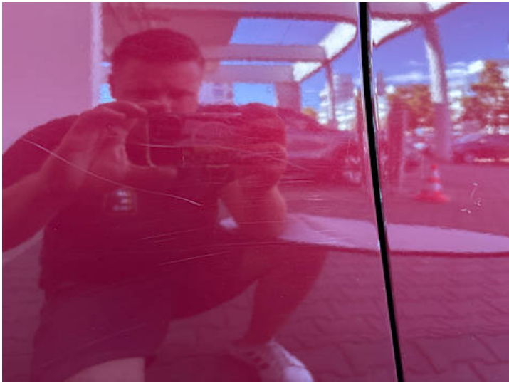
Seitenteil hinten rechts (Kratzer)
