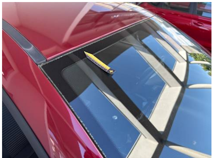
Windschutzscheibe (Anderer Schaden): Zieht Luft
