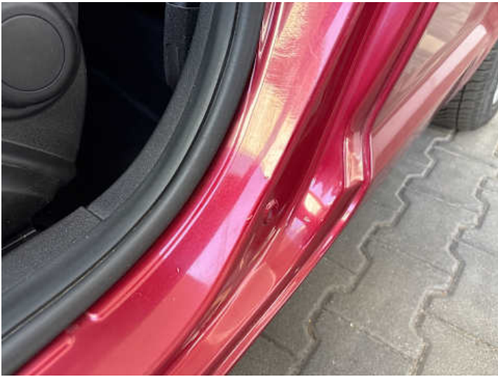
Schweller links (Kratzer, Delle)
