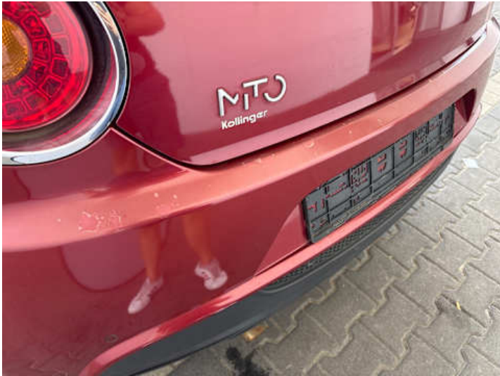
Stoßstange hinten (Lackschaden)
