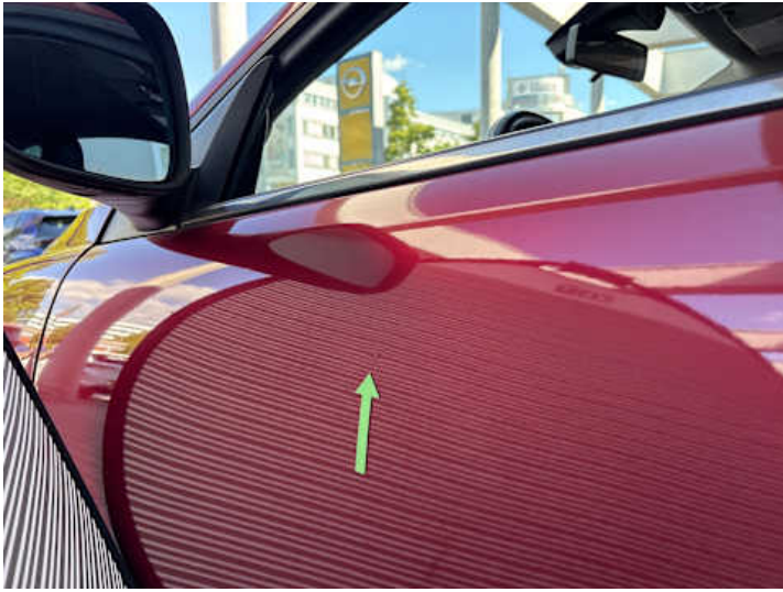
Fahrtür (Kratzer, Delle)
