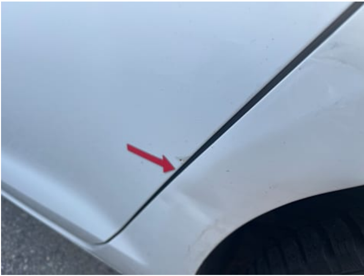
Türe hinten links (Lackschaden, Verformung)
