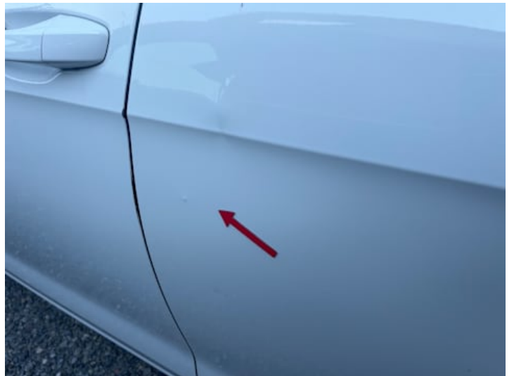
Türe hinten links (Lackschaden, Verformung)
