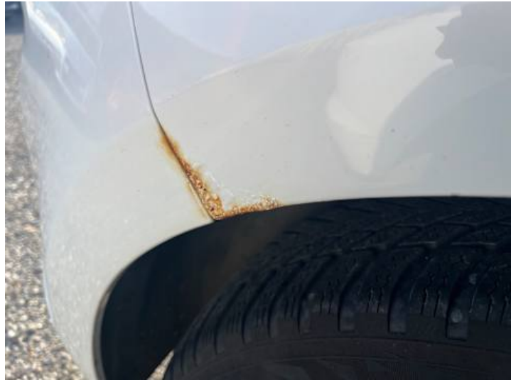
Seitenteil hinten rechts (Rost)
