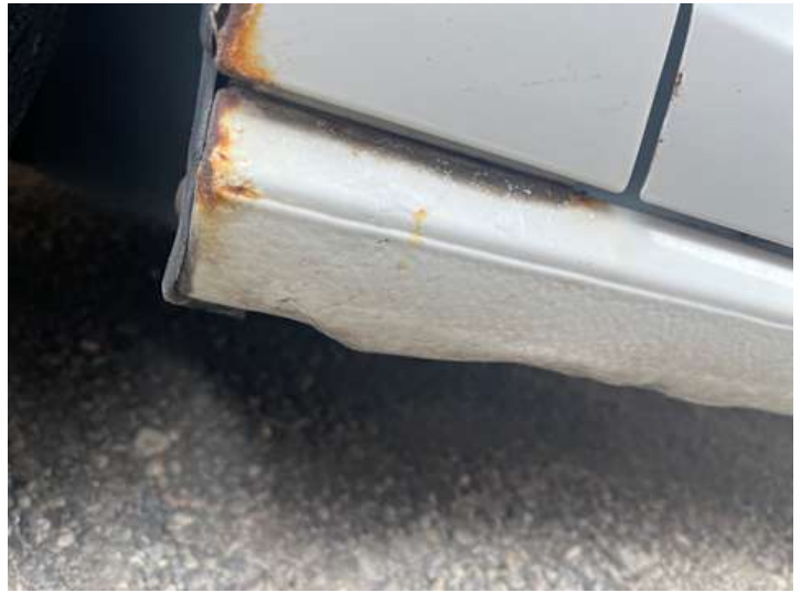
Schweller links (Rost, Verformung)
