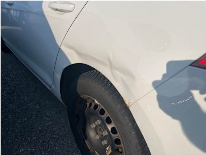
Seitenteil hinten links (Verformung, Lackschaden, Rost)
