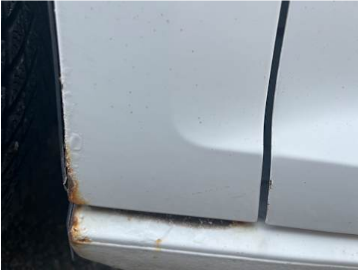
Kotflügel vorne links (Rost, Lackschaden)
