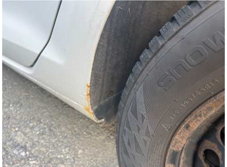
Seitenteil hinten links (Verformung, Lackschaden, Rost)
