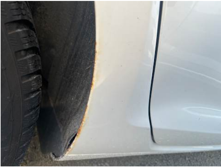
Seitenteil hinten rechts (Rost)
