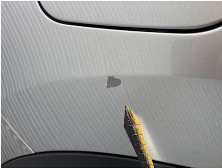
Seitenteil hinten rechts (Lackschaden, Unsachgemäß instand gesetzt)
