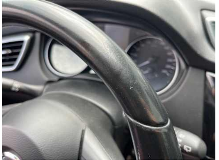
Innenraum (Diverse Schäden, Kratzer)
