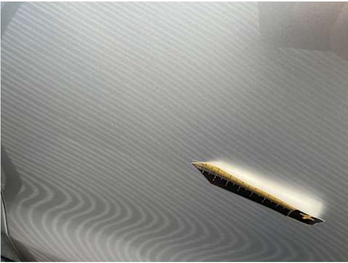
Beifahrertür (Unsachgemäß instand gesetzt, Lackschaden, Kratzer)
