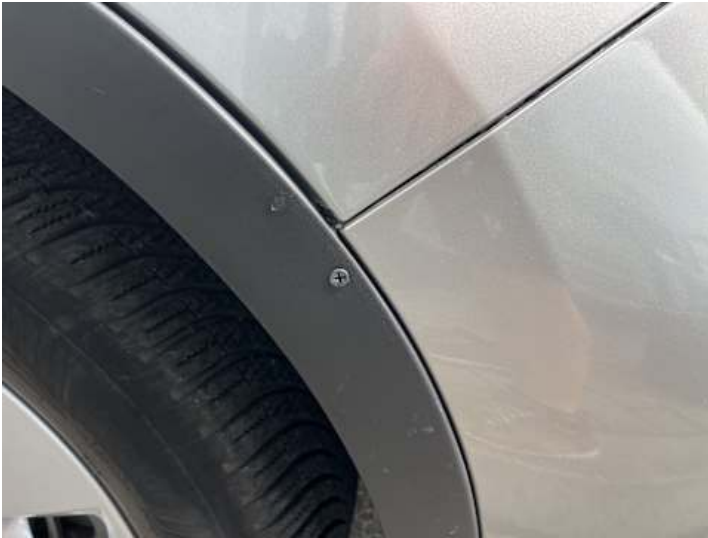
Stoßstange vorne (Unsachgemäß instand gesetzt, Spaltmaße ungenau)
