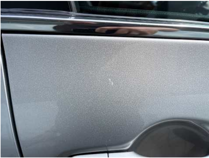
Beifahrertür (Unsachgemäß instand gesetzt, Lackschaden, Kratzer)
