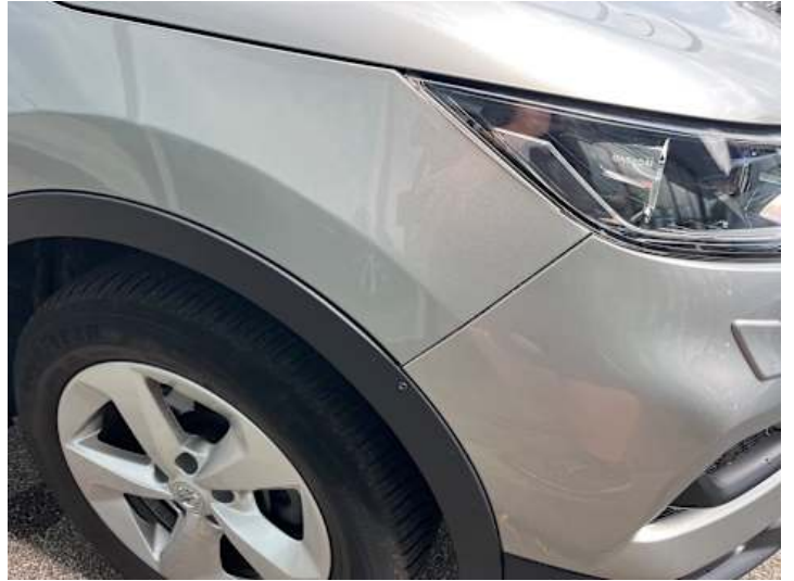
Stoßstange vorne (Unsachgemäß instand gesetzt, Spaltmaße ungenau)
