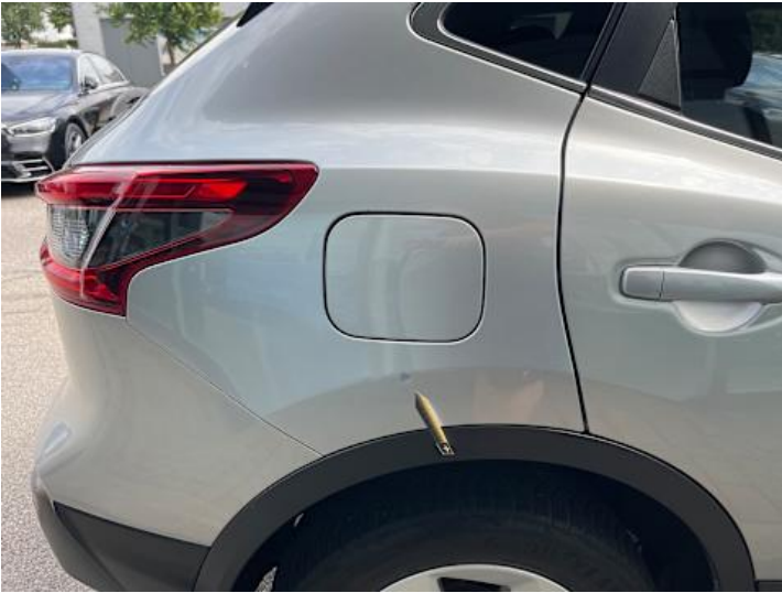
Seitenteil hinten rechts (Lackschaden, Unsachgemäß instand gesetzt)
