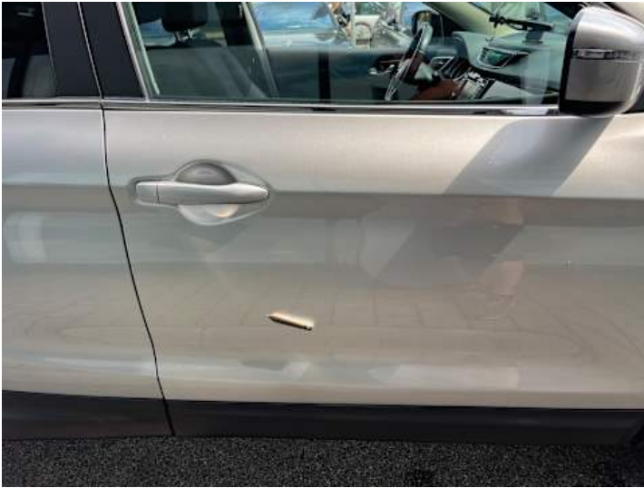
Beifahrertür (Unsachgemäß instand gesetzt, Lackschaden, Kratzer)
