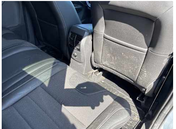
Innenraum (Verschmutzung, Verschleiß)
