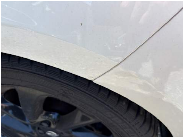
Seitenteil hinten links (Kratzer, Lackschaden, Rost)
