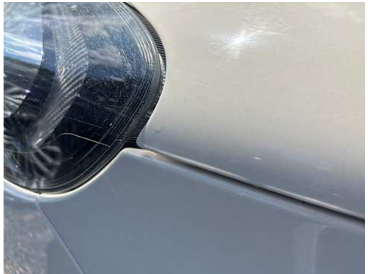
Motorhaube (Lackschaden, Unsachgemäß instand gesetzt)
