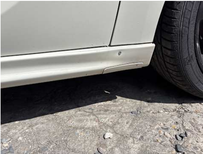
Schweller rechts (Lackschaden, Unsachgemäß instand gesetzt)
