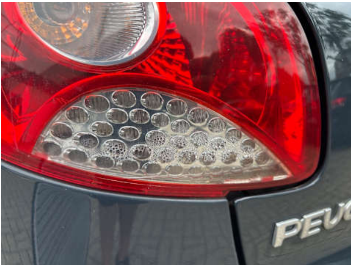
Rücklicht (links) (Undicht)
