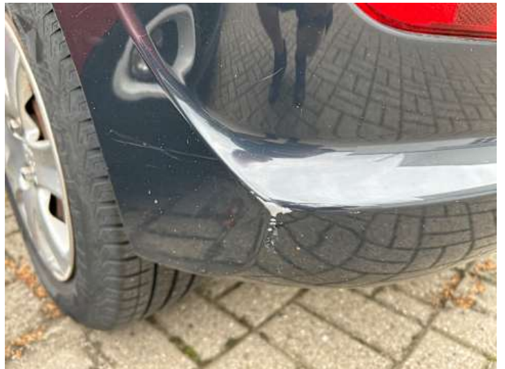
Stoßstange hinten (Verformung, Kratzer, Lackschaden)
