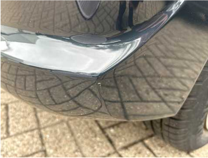
Stoßstange hinten (Verformung, Kratzer, Lackschaden)
