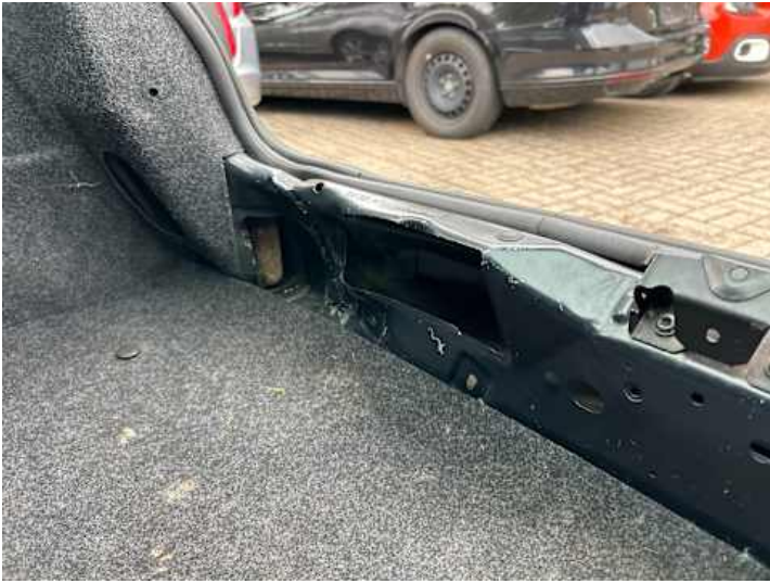
Heckklappe (Verformung, Lackschaden, Rost)
