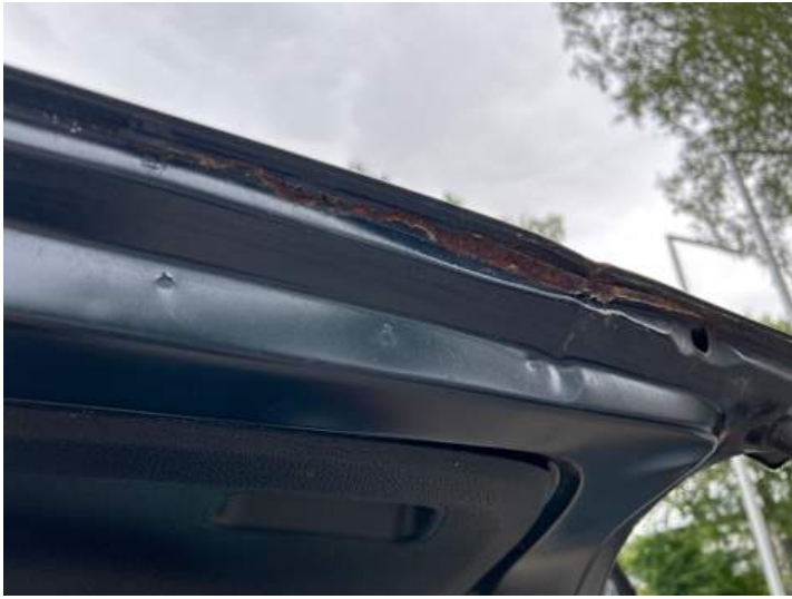
Heckklappe (Verformung, Lackschaden, Rost)
