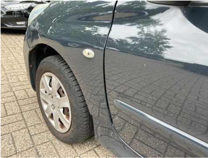
Kotflügel vorne links (Verformung, Spaltmaße ungenau, Lackschaden, Delle)
