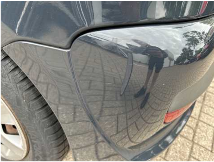
Stoßstange hinten (Verformung, Kratzer, Lackschaden)
