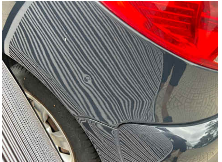
Seitenteil hinten links (Delle, Kratzer)
