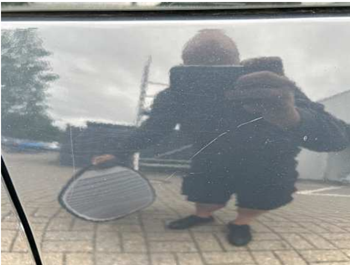
Seitenteil hinten links (Delle, Kratzer)
