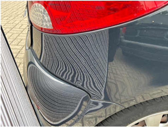
Seitenteil hinten rechts (Kratzer, Delle)
