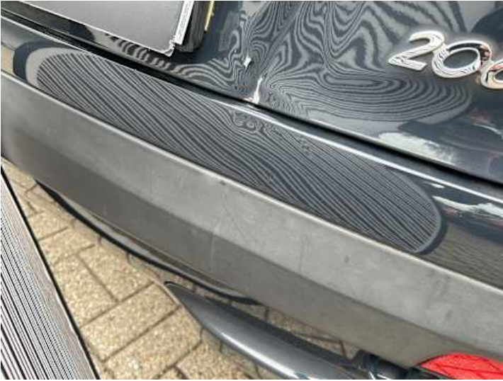
Stoßstange hinten (Verformung, Kratzer, Lackschaden)
