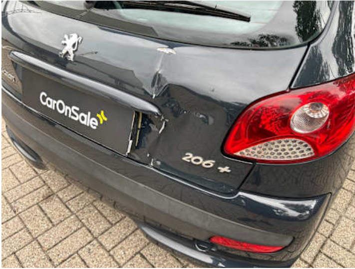
Heckklappe (Verformung, Lackschaden, Rost)
