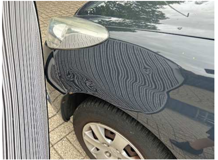
Kotflügel vorne links (Verformung, Spaltmaße ungenau, Lackschaden, Delle)
