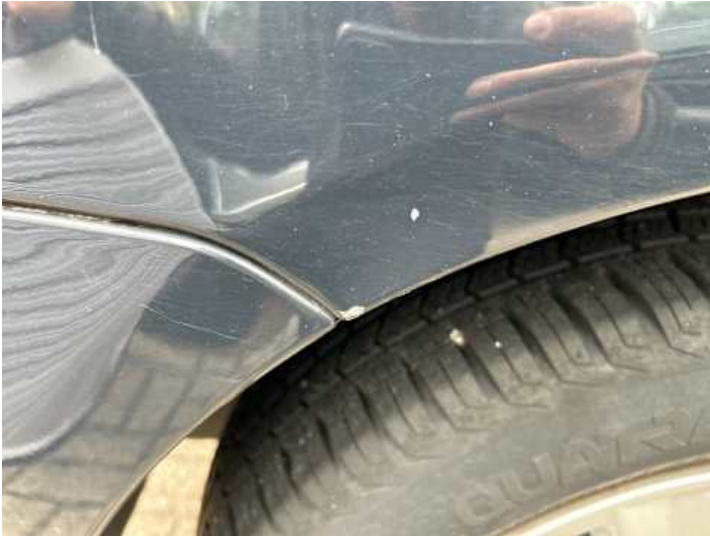
Seitenteil hinten rechts (Kratzer, Delle)
