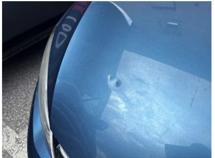
Motorhaube (Lackschaden, Delle)
