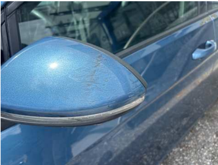
Fahrertür (Lackschaden, Kratzer)
