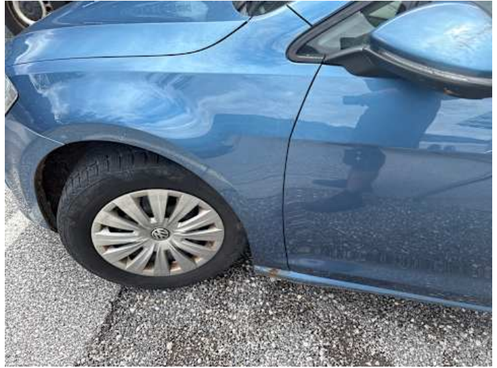
Kotflügel vorne links (Lackschaden, Rost)
