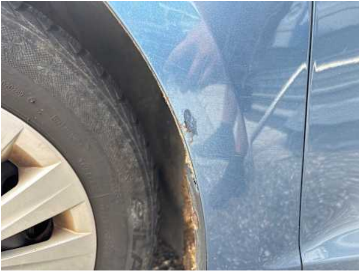
Kotflügel vorne links (Lackschaden, Rost)
