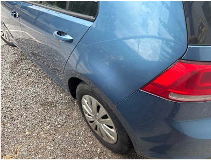
Seitenteil hinten links (Lackschaden, Rost)
