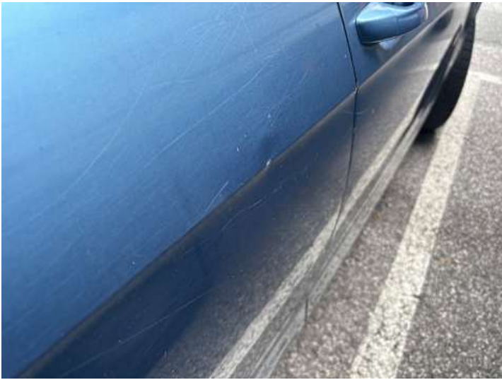
Türe hinten rechts (Delle, Lackschaden)
