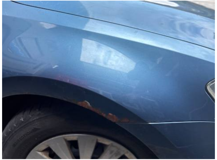
Kotflügel vorne rechts (Lackschaden, Rost)
