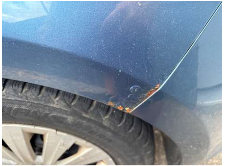
Seitenteil hinten links (Lackschaden, Rost)
