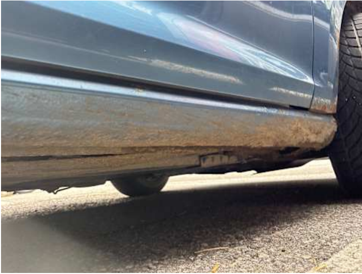
Schweller rechts (Rost)
