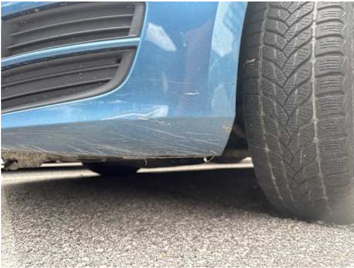
Stoßstange vorne (Lackschaden, Kratzer)
