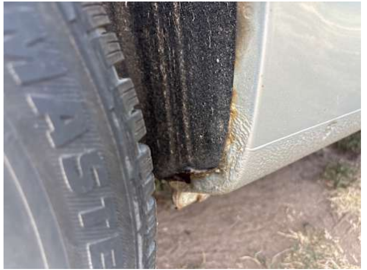
Schweller rechts (Rost)
