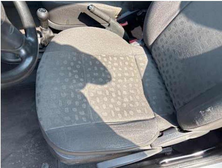
Innenraum (Verschmutzung, Verschleiß)
