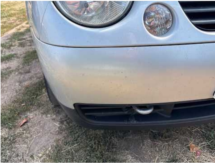
Stoßstange vorne (Ausgeblichen/Matt, Unsachgemäß instand gesetzt)
