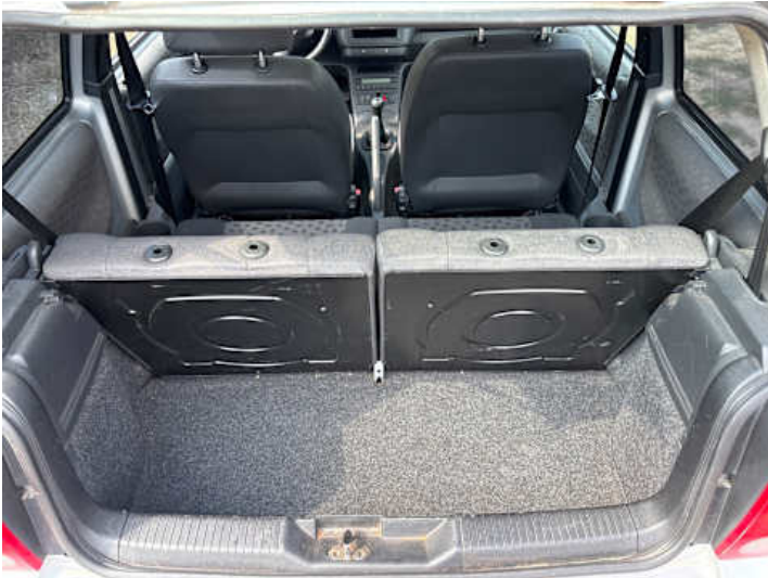
Innenraum (Anderer Schaden): Kopfstützen hinten fehlen
