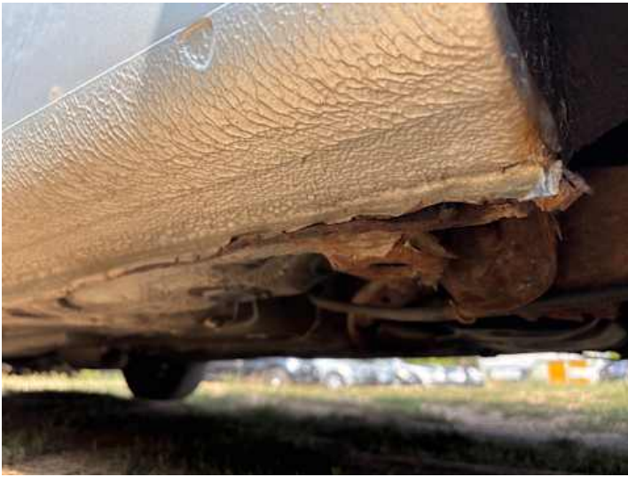
Schweller links (Verformung, Rost)
