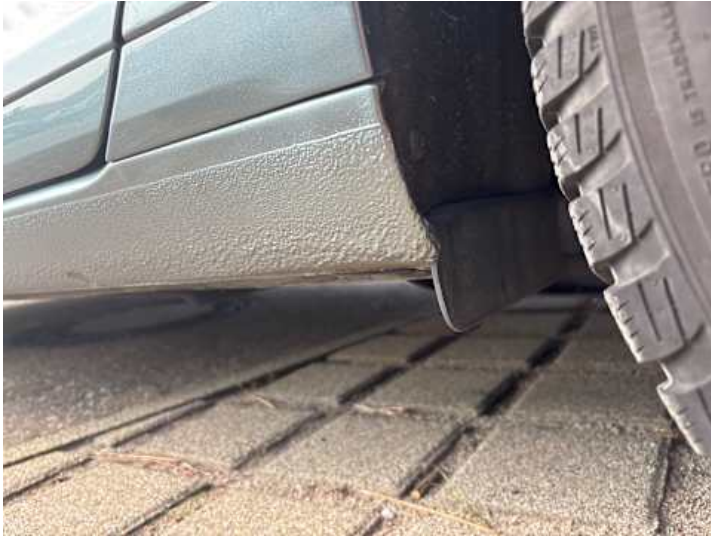
Schweller links (Rost)
