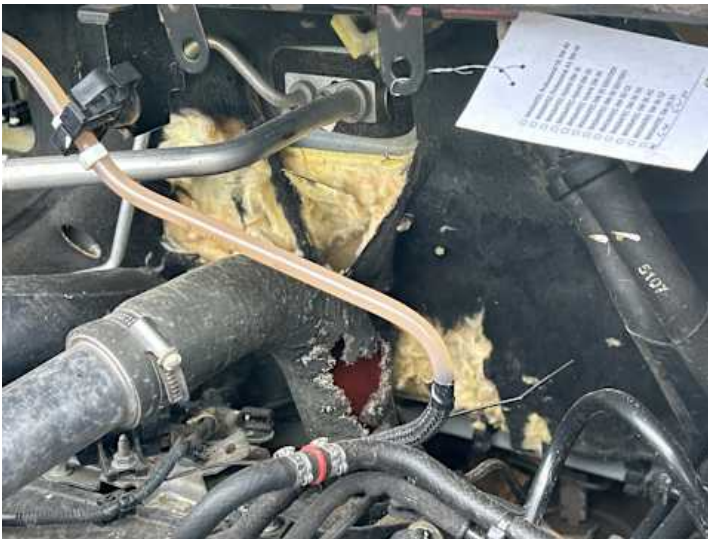
Motorhaube (Anderer Schaden): Marderbiss
