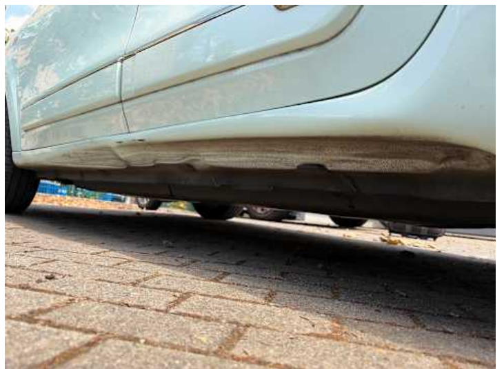
Schweller links (Verformung)
