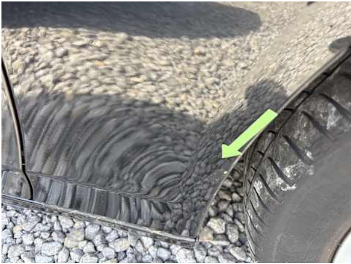
Kotflügel vorne rechts (Kratzer, Lackschaden)
