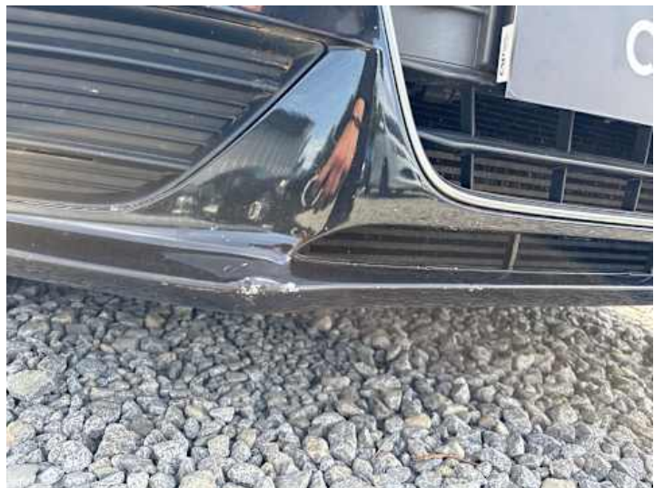
Stoßstange vorne (Kratzer, Delle, Steinschlag)
