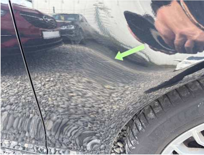
Kotflügel vorne rechts (Kratzer, Lackschaden)
