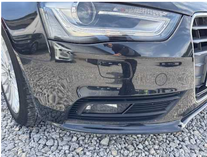
Stoßstange vorne (Kratzer, Delle, Steinschlag)
