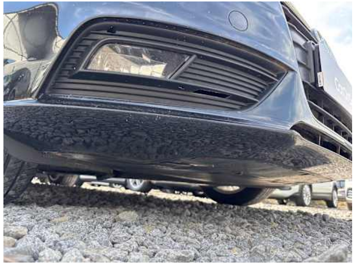
Stoßstange vorne (Kratzer, Delle, Steinschlag)
