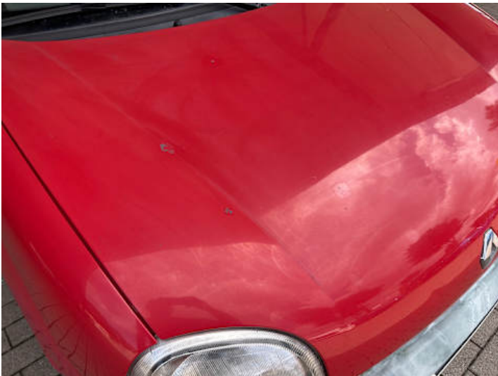
Motorhaube (Lackschaden, Delle)
