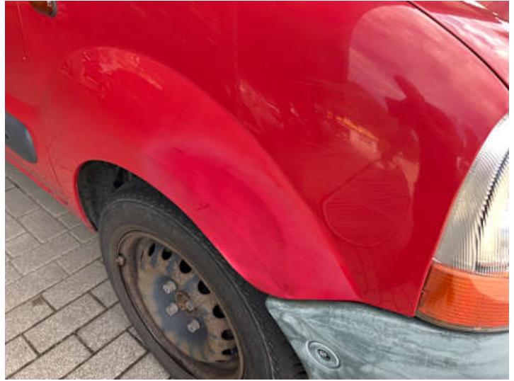
Kotflügel vorne rechts (Verformung, Lackschaden, Delle)
