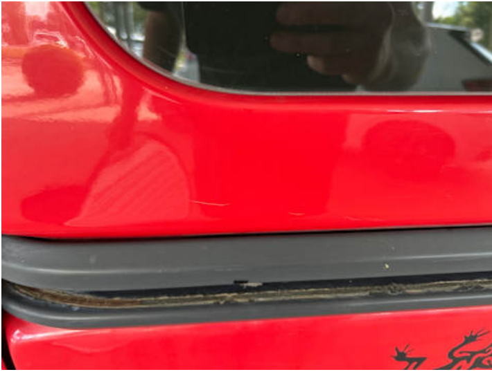
Seitenteil hinten links (Verformung, Delle, Kratzer)
