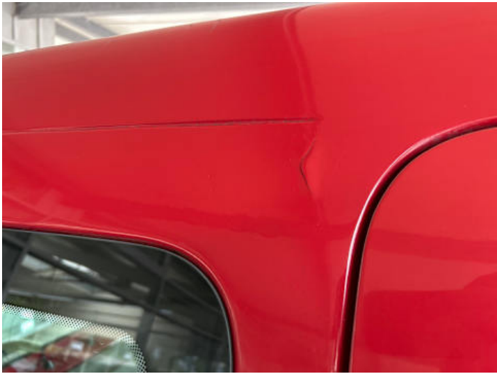
Seitenteil hinten rechts (Lackschaden, Kratzer, Delle, Unsachgemäß instand gesetzt)
