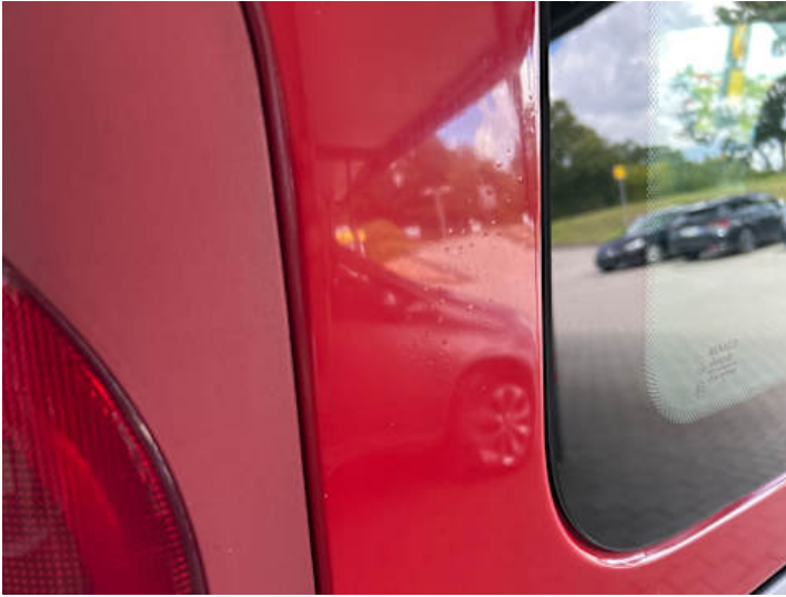
Seitenteil hinten rechts (Lackschaden, Kratzer, Delle, Unsachgemäß instand gesetzt)
