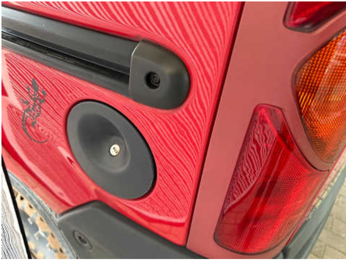
Seitenteil hinten links (Verformung, Delle, Kratzer)
