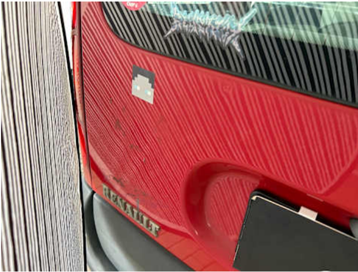
Heckklappe (Kratzer, Delle, Rost)
