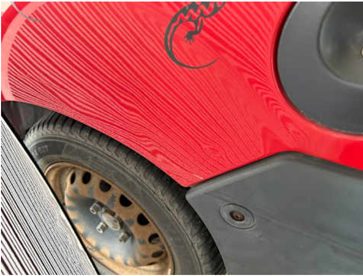
Seitenteil hinten links (Verformung, Delle, Kratzer)
