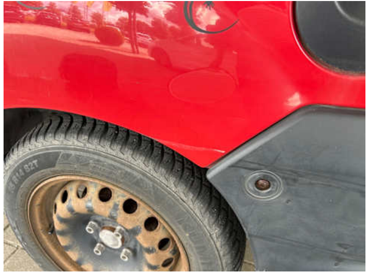
Seitenteil hinten links (Verformung, Delle, Kratzer)
