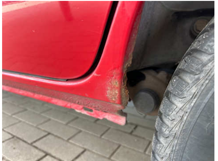
Schweller links (Rost)
