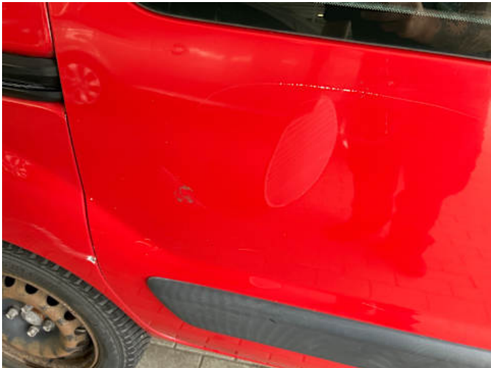
Türe hinten rechts (Kratzer, Lackschaden)
