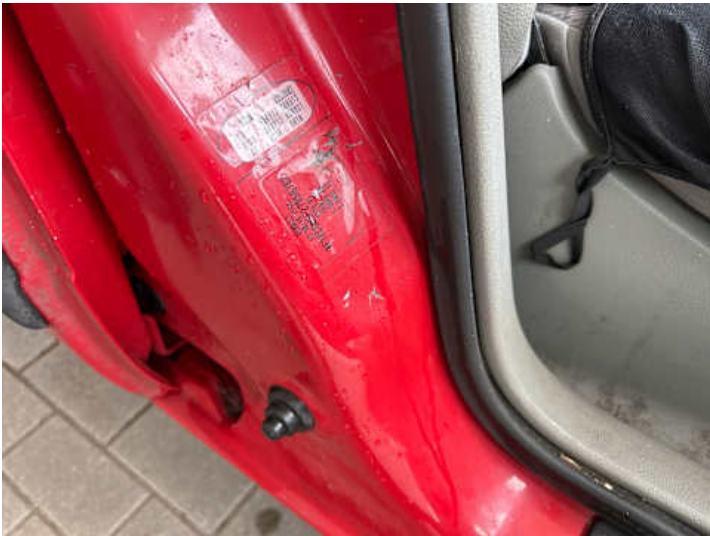
Beifahrertür (Kratzer, Delle)
