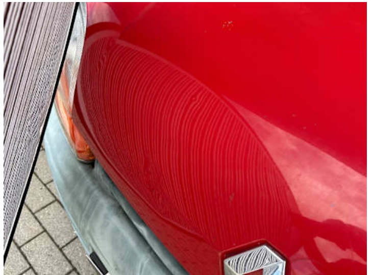
Motorhaube (Lackschaden, Delle)
