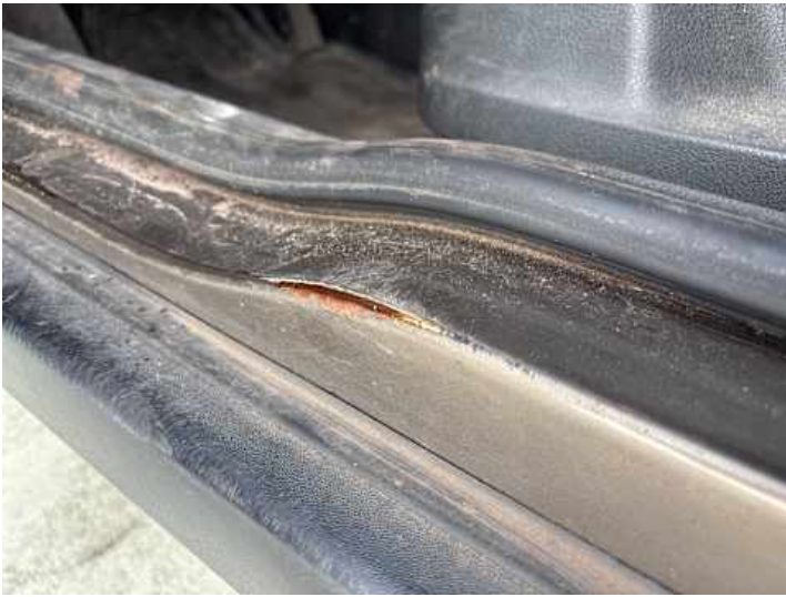
Schweller links (Rost)
