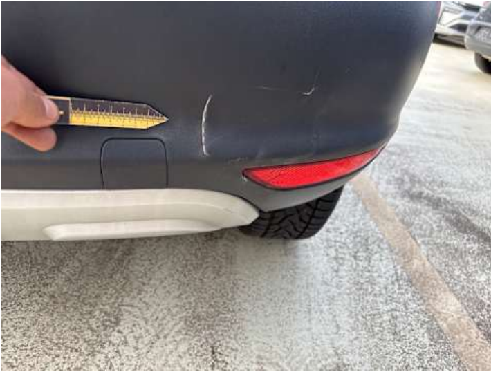
Stoßstange hinten (Lackschaden, Riss/Bruch)
