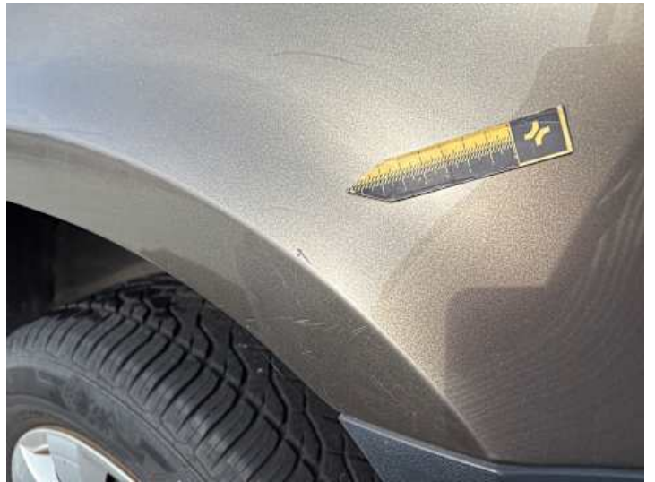
Seitenteil hinten links (Lackschaden, Kratzer)
