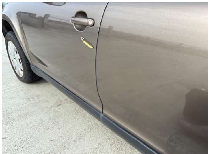
Fahrtür (Lackschaden, Rost)
