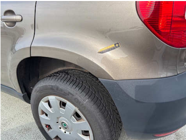
Seitenteil hinten links (Lackschaden, Kratzer)
