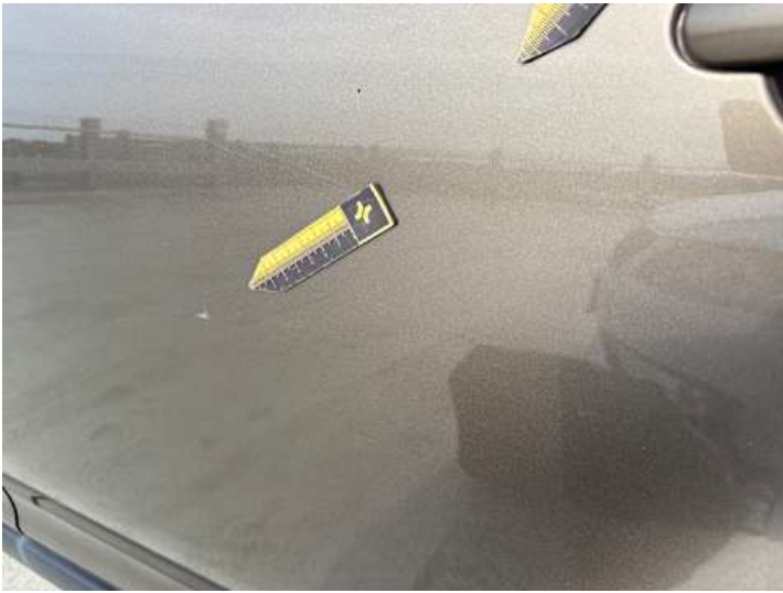
Türe hinten links (Lackschaden, Kratzer)
