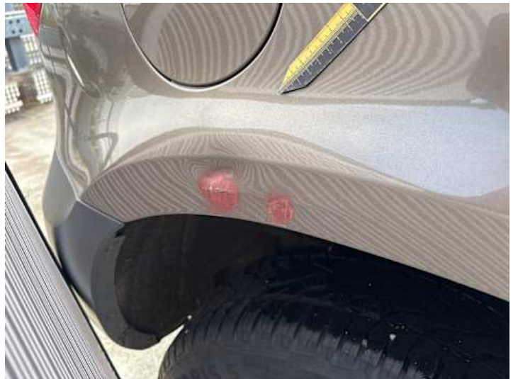
Seitenteil hinten rechts (Lackschaden, Verformung)
