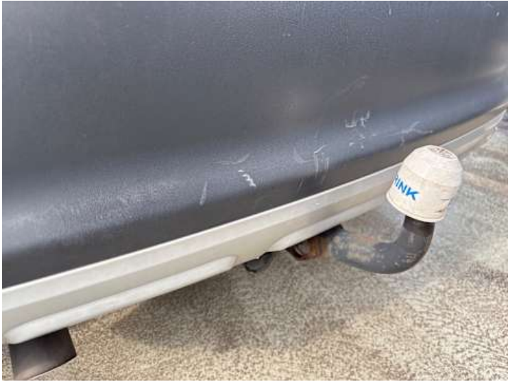
Stoßstange hinten (Lackschaden)
