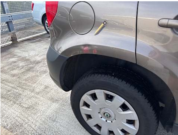
Seitenteil hinten rechts (Lackschaden, Verformung)
