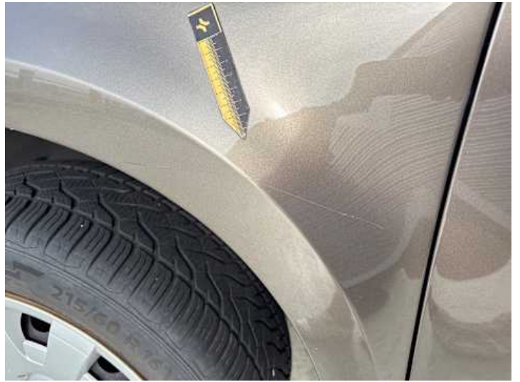
Kotflügel vorne links (Kratzer)
