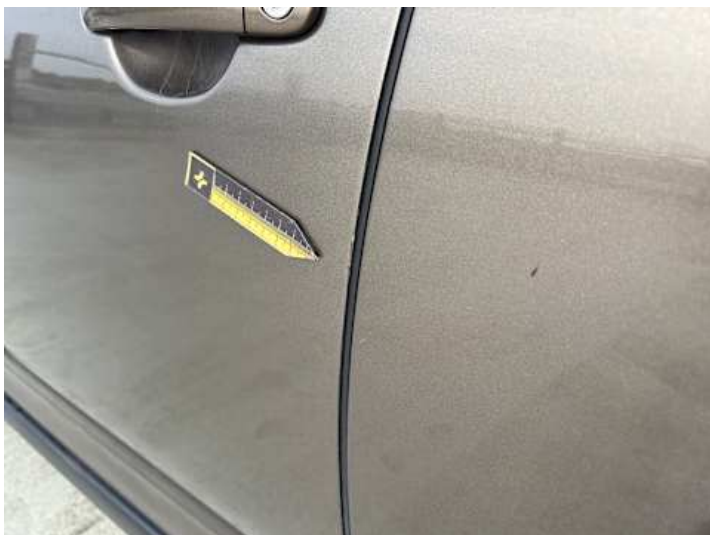
Fahrtür (Lackschaden, Rost)
