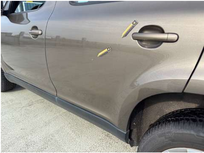
Türe hinten links (Lackschaden, Kratzer)
