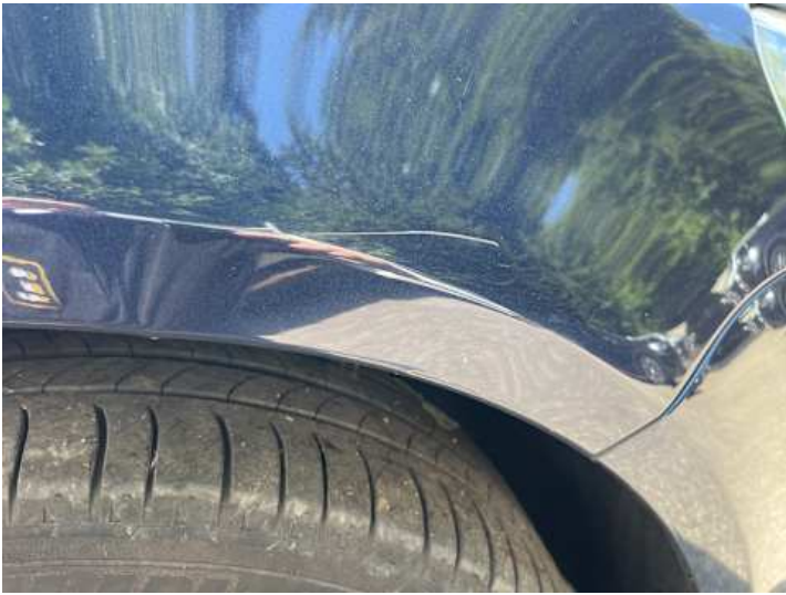
Kotflügel vorne rechts (Kratzer, Lackschaden, Verformung)
