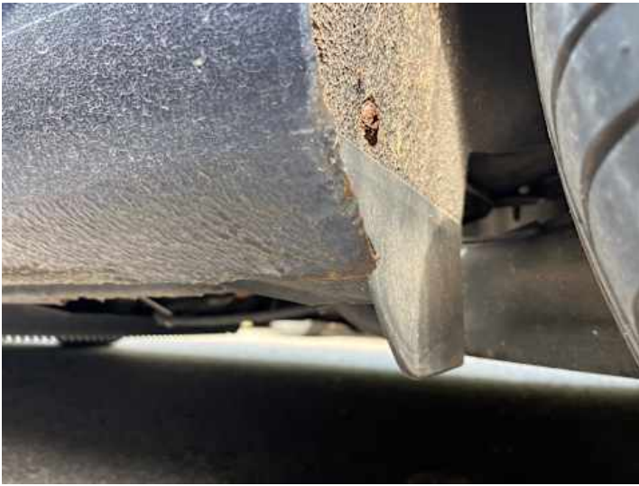
Schweller links (Rost, Lackschaden)
