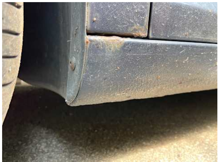
Schweller links (Rost, Lackschaden)
