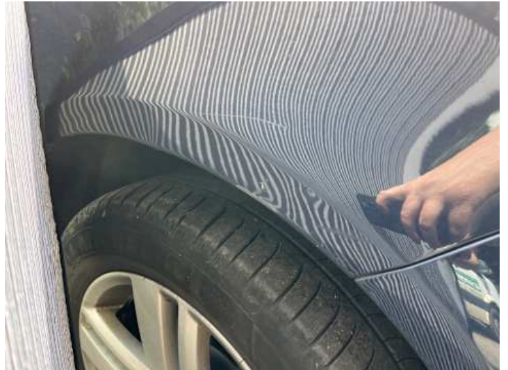
Kotflügel vorne rechts (Kratzer, Lackschaden, Verformung)
