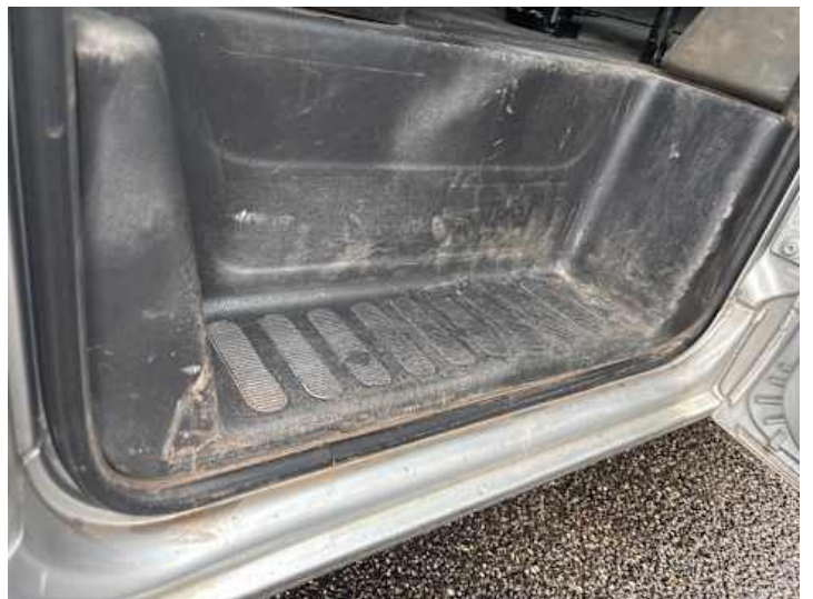
Schweller rechts (Lackschaden)
