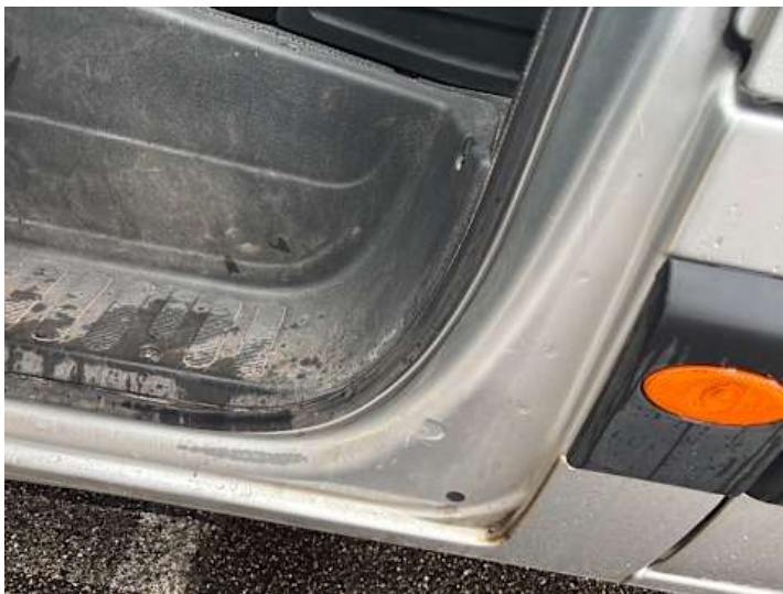
Schweller links (Lackschaden)
