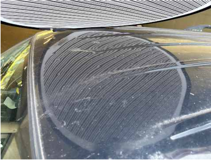
Dach (Delle, Verformung)
