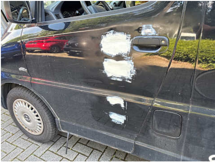
Fahrtür (Lackschaden, Rost)
