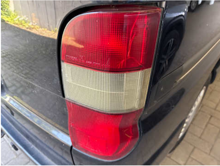
Rücklicht (rechts) (Riss/Bruch)
