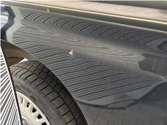
Seitenteil hinten rechts (Verformung, Rost)
