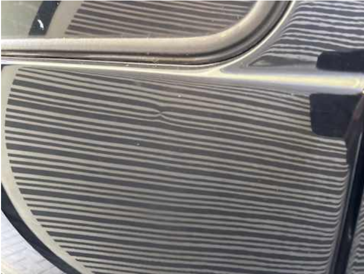
Seitenteil hinten rechts (Verformung, Rost)
