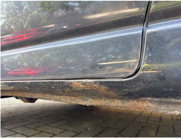
Fahrtür (Lackschaden, Rost)
