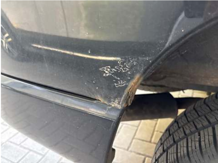
Seitenteil hinten rechts (Verformung, Rost)
