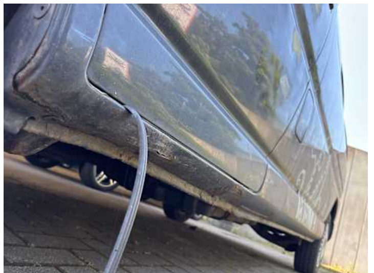
Fahrrertür (Lackschaden, Rost)
