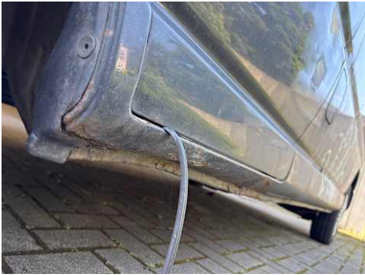
Schweller links (Rost)
