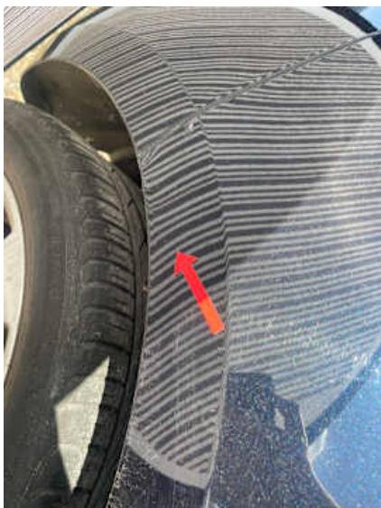
Seitenteil hinten rechts (Delle)
