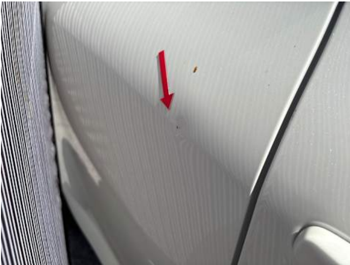
Türe hinten rechts (Delle, Lackschaden)
