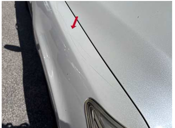
Kotflügel vorne rechts (Kratzer)
