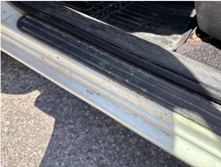
Schweller links (Rost)
