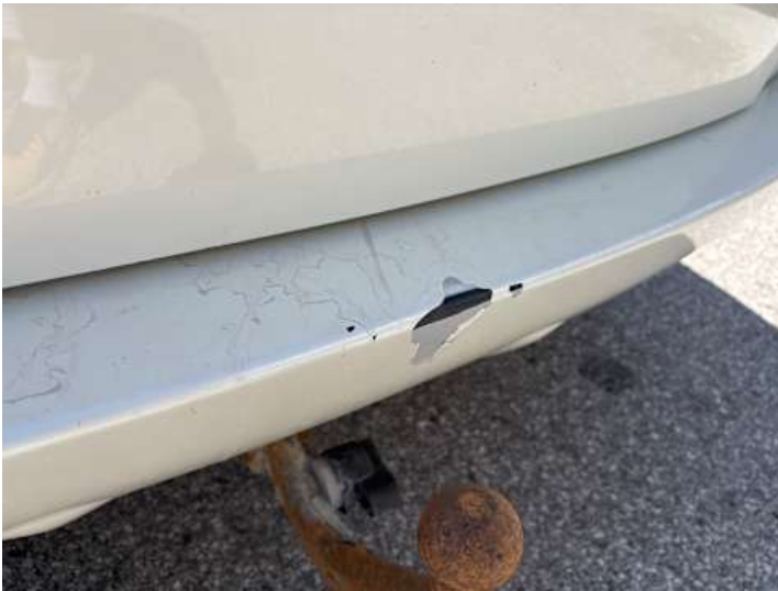
Stoßstange hinten (Lackschaden, Verformung)
