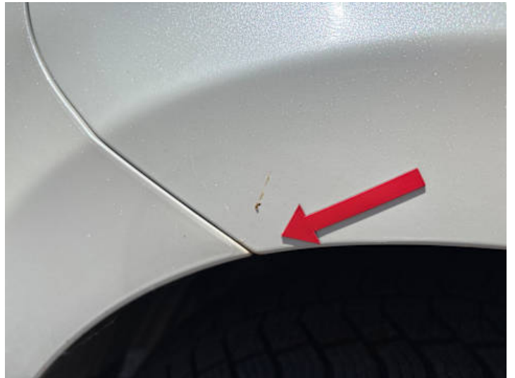
Kotflügel vorne links (Rost)
