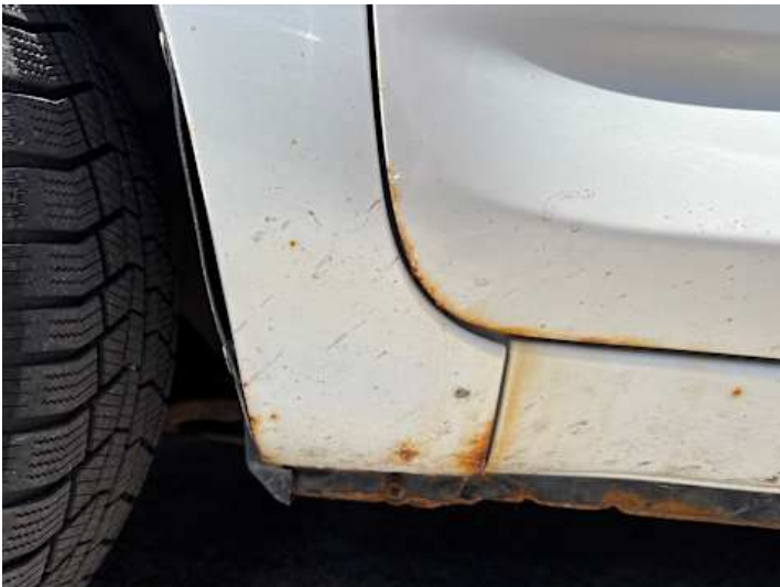
Kotflügel vorne links (Rost)
