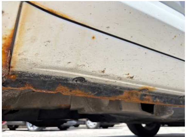
Schweller links (Rost)
