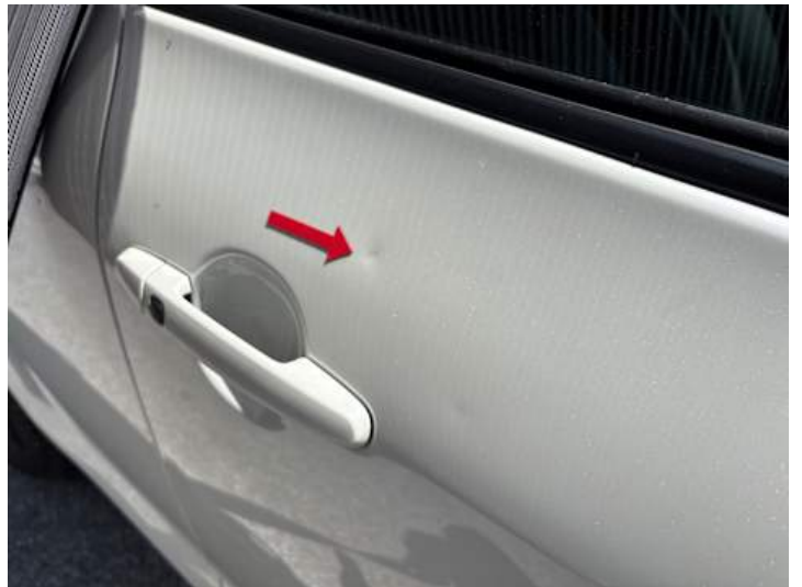
Beifahrtür (Delle, Lackschaden)
