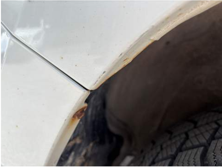
Seitenteil hinten rechts (Lackschaden)
