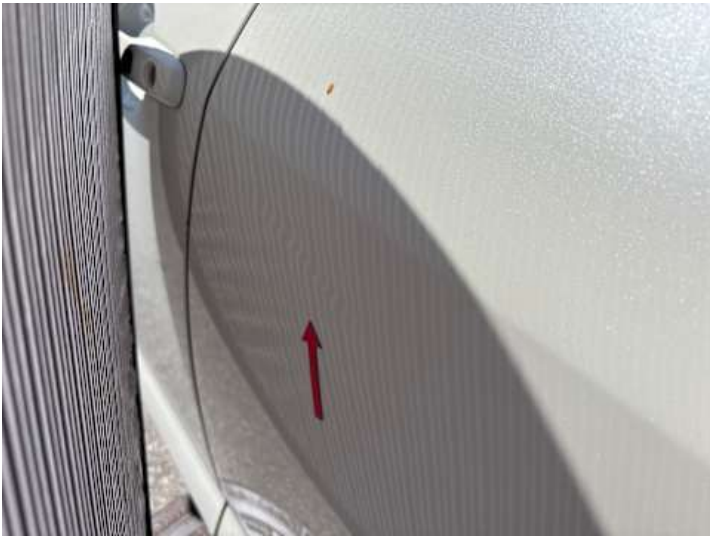
Türe hinten links (Delle)
