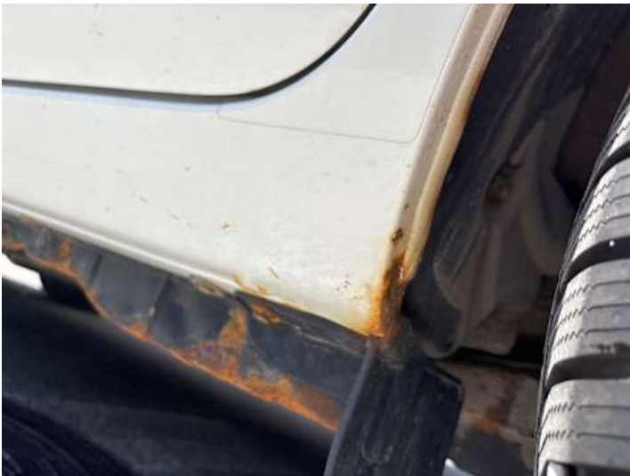
Schweller links (Rost)
