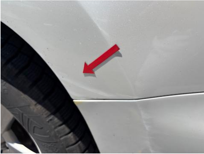
Seitenteil hinten links (Kratzer)
