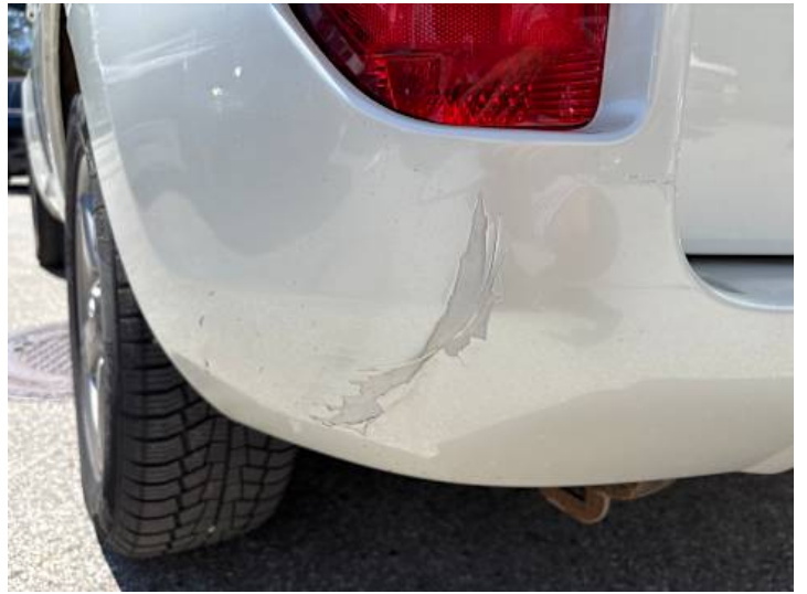
Stoßstange hinten (Lackschaden, Verformung)
