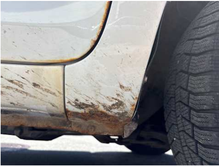
Kotflügel vorne rechts (Rost)
