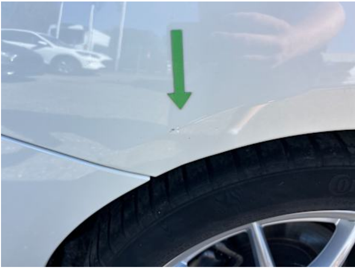
Seitenteil hinten rechts (Riss/Bruch)
