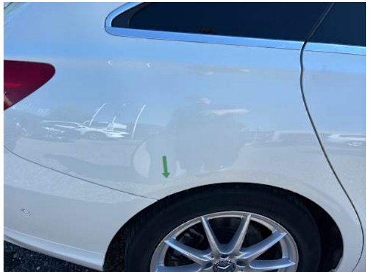
Seitenteil hinten rechts (Riss/Bruch)
