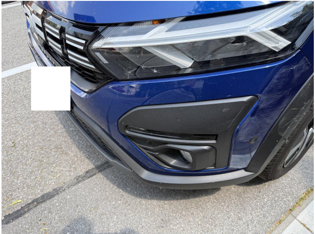
Blende Stoßfänger vorne links beschädigt/verschrammt
