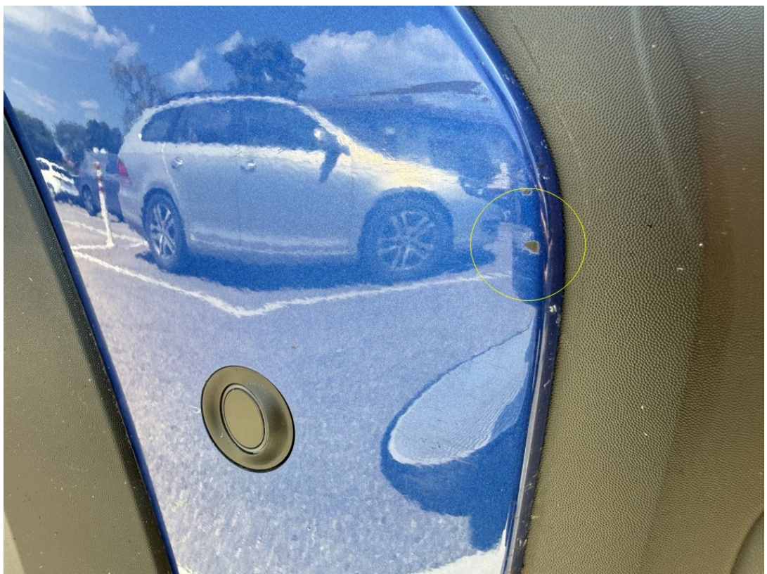
Altschaden: Verkleidung-Stoßfänger vorne rechts beschädigt/verschrammt
