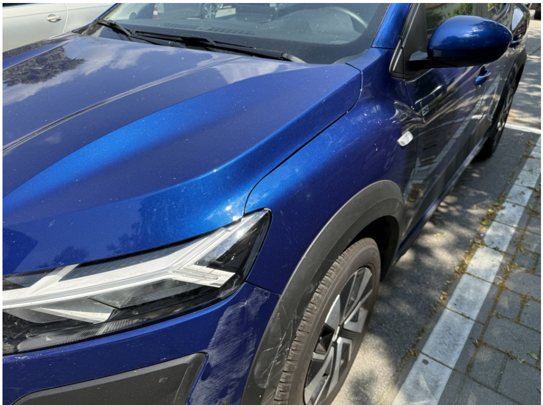
Kotflügel vorne links beschädigt/deformiert im Kantenbereich
