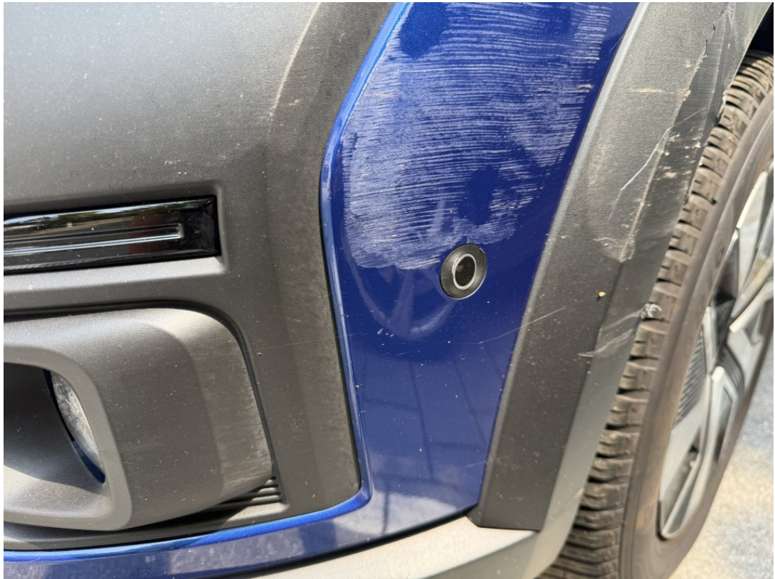
PDC - Sensor vorne links aussen beschädigt
