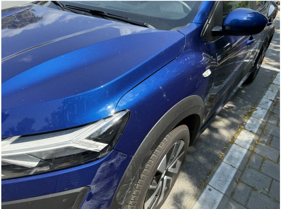
Kotflügel vorne links beschädigt/deformiert im Kantenbereich
