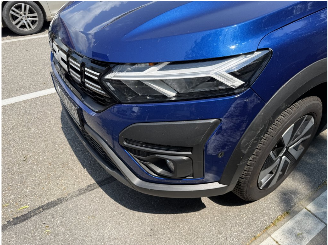
Verkleidung-Stoßfänger vorne beschädigt/plastisch verformt
