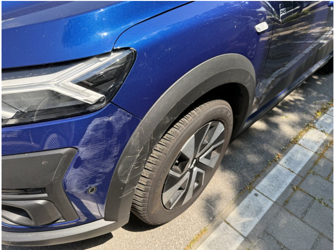
Radlaufblende vorne links beschädigt/verschrammt
