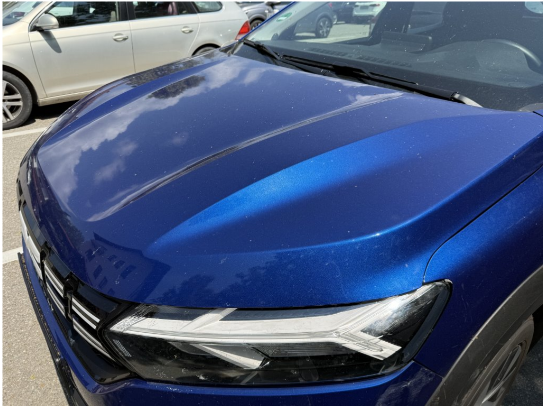
Motorhaube vorne links Lackierung beschädigt
