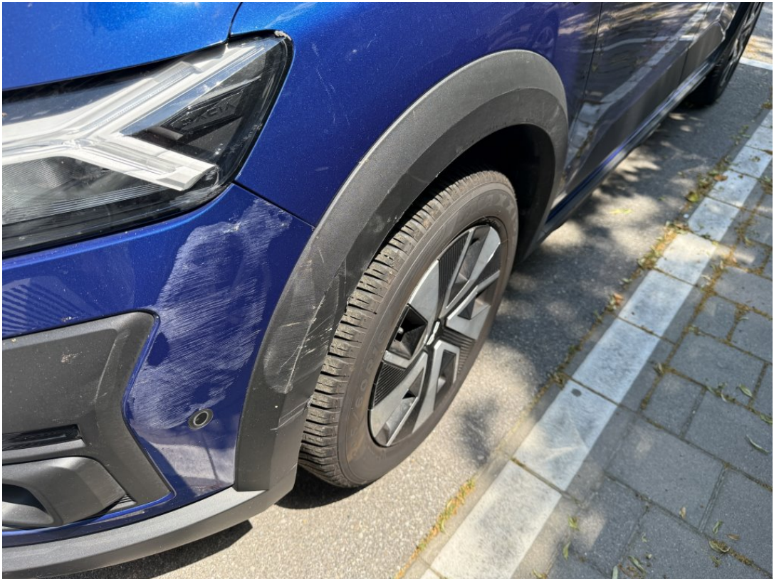
Radlaufblende vorne links beschädigt/verschrammt
