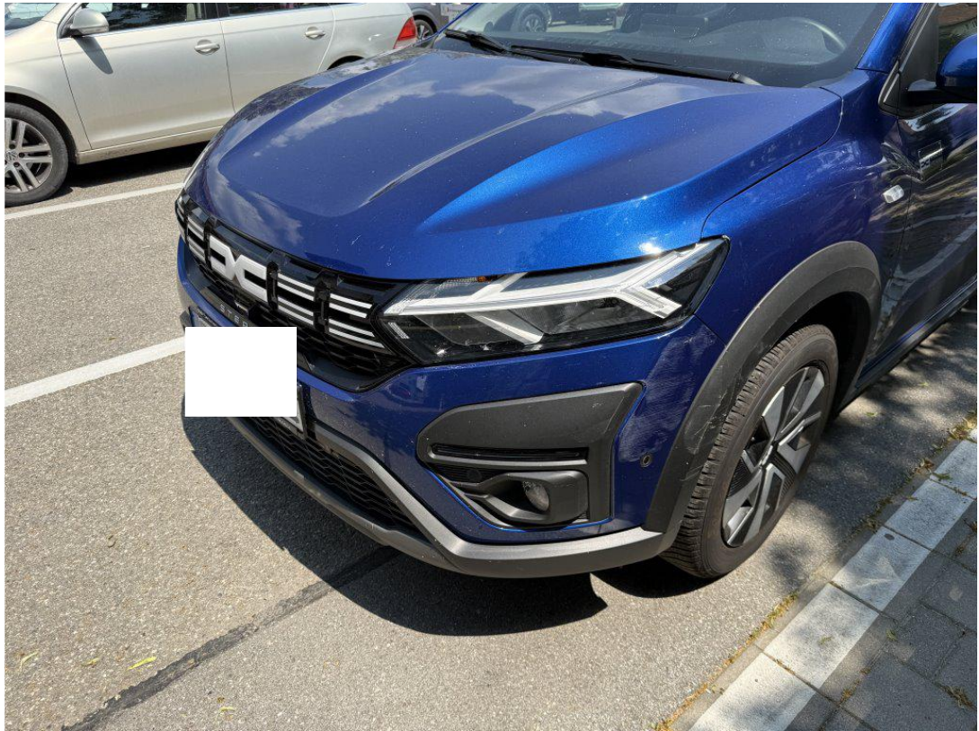
Verkleidung-Stoßfänger vorne beschädigt/plastisch verformt
