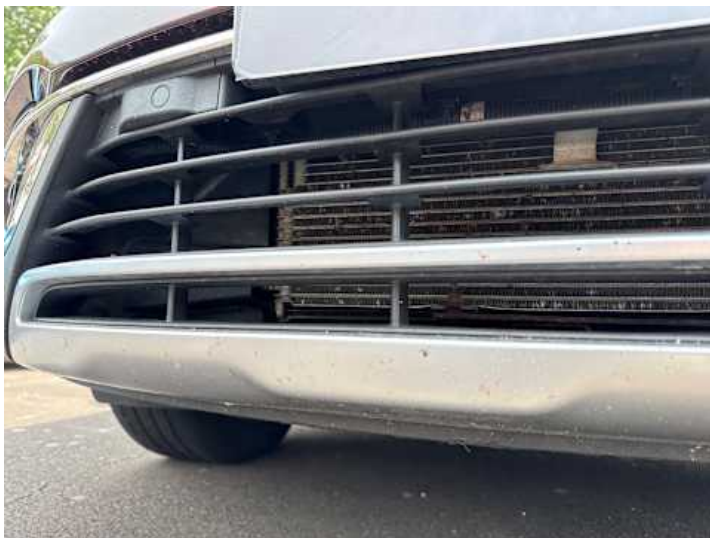
Stoßstange vorne (Steinschlag)
