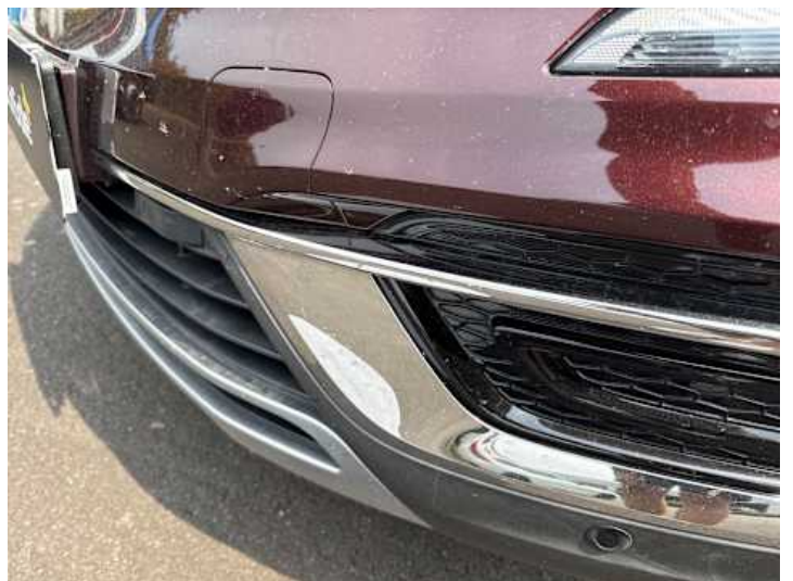
Stoßstange vorne (Steinschlag)
