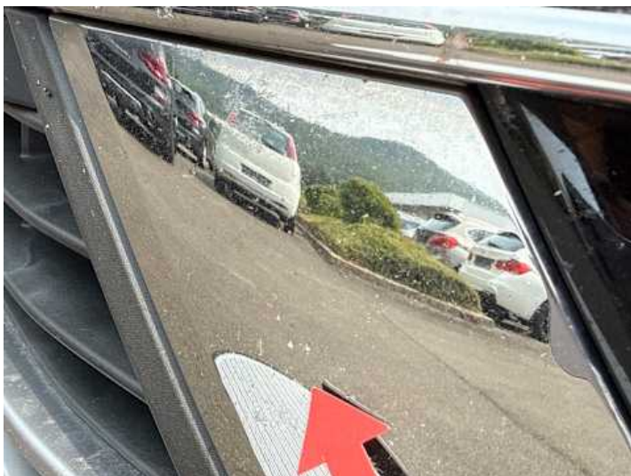
Stoßstange vorne (Steinschlag)
