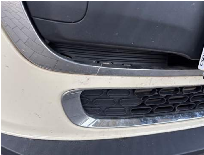
Stoßstange vorne (Riss/Bruch)
