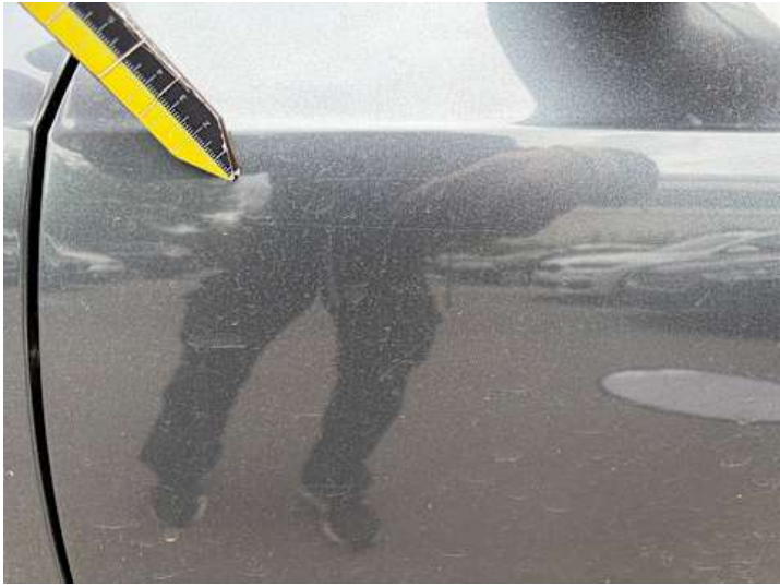
Fahrertür (Lackschaden, Kratzer)
