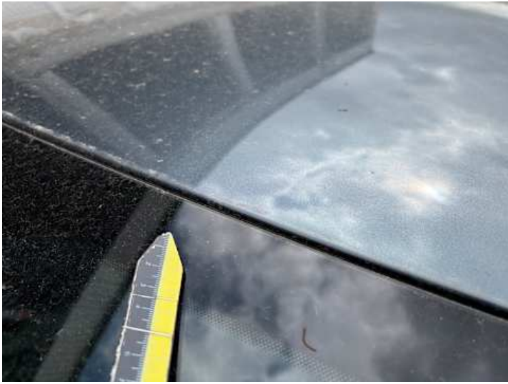
Dach (Lackschaden, Steinschlag)
