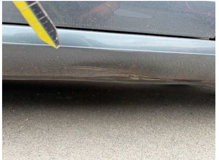
Schweller links (Lackschaden, Verformung)
