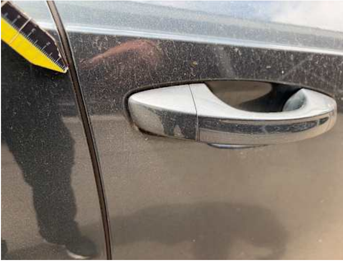
Beifahrertür (Lackschaden, Kratzer)
