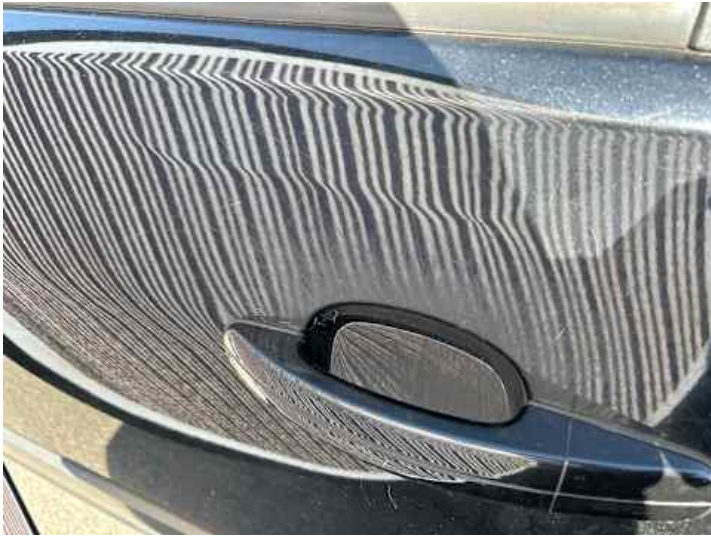
Türe hinten links (Verformung)
