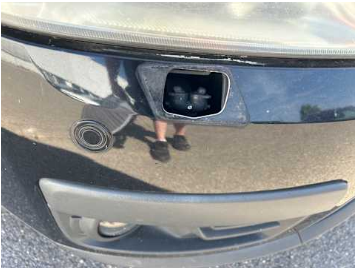
Stoßstange vorne (Riss/Bruch)
