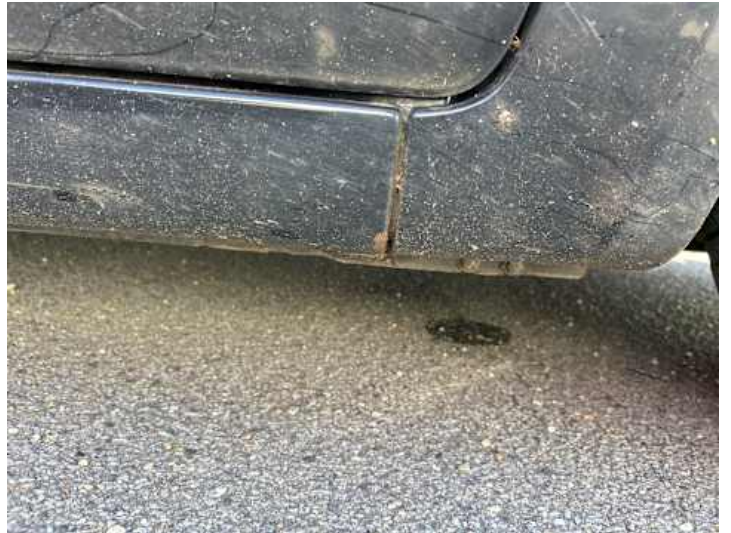
Schweller rechts (Rost)
