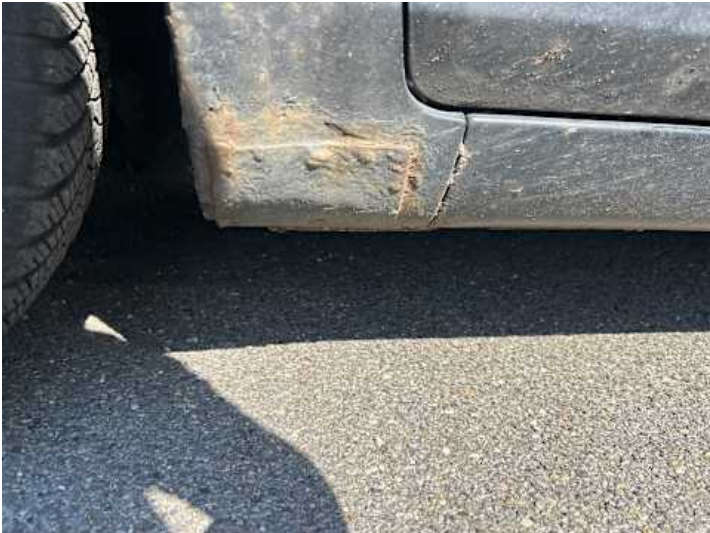
Schweller links (Rost)
