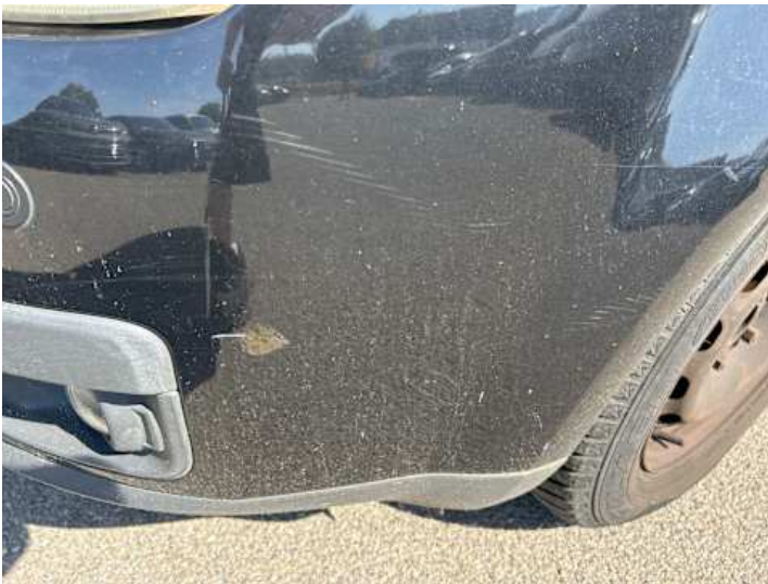
Stoßstange vorne (Kratzer)
