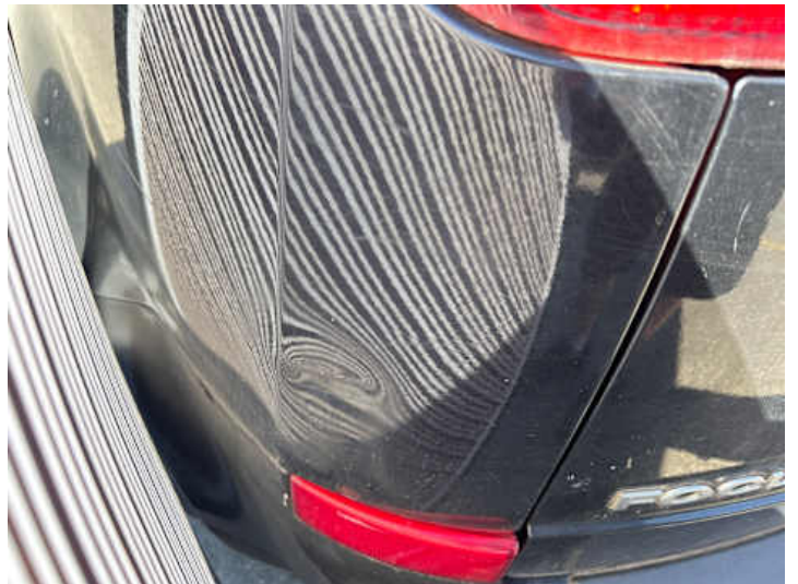
Seitenteil hinten links (Verformung, Kratzer)
