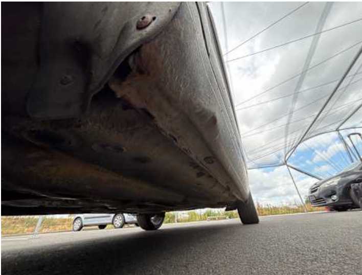
Schweller links (Rost, Verformung)
