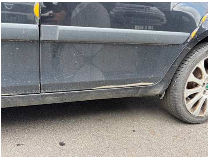
Türe hinten links (Rost)
