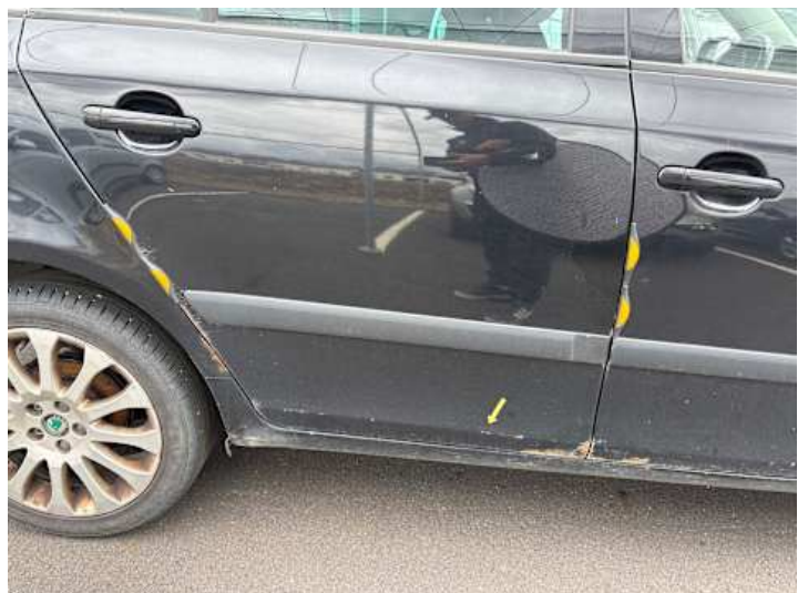
Türe hinten rechts (Rost)
