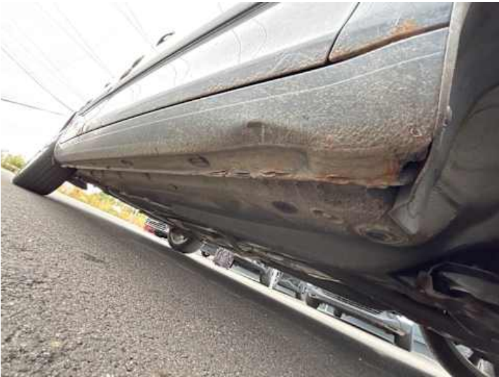
Schweller rechts (Rost, Verformung)
