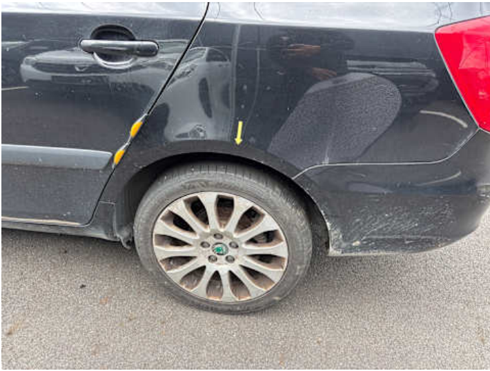
Seitenteil hinten links (Rost)
