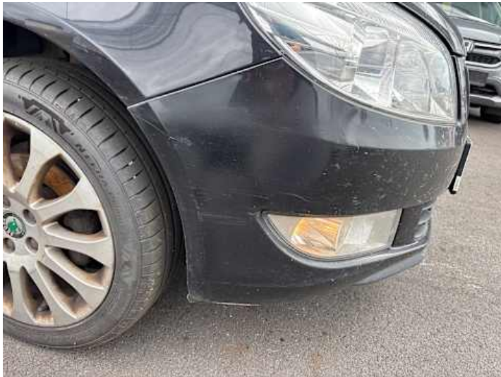
Stoßstange vorne (Unsachgemäß instand gesetzt)
