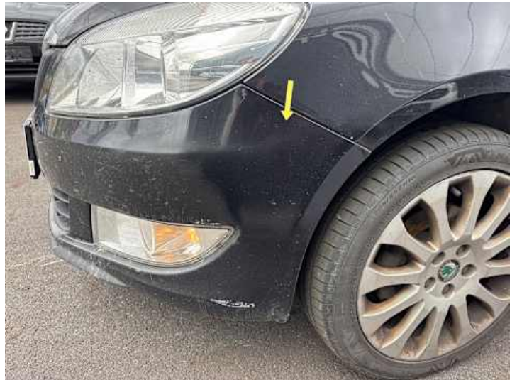
Stoßstange vorne (Unsachgemäß instand gesetzt)
