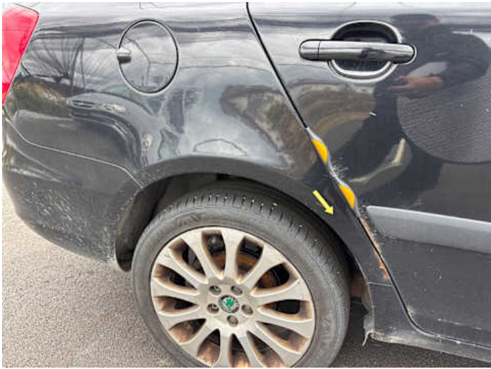
Seitenteil hinten rechts (Rost)
