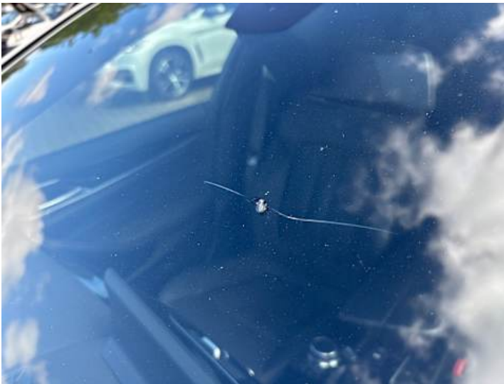
Windschutzscheibe (Steinschlag, Riss/Bruch)
