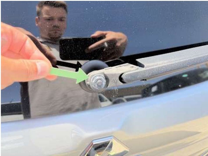
Heckklappe (Anderer Schaden): Scheibenwischer Abdeckung fehlt
