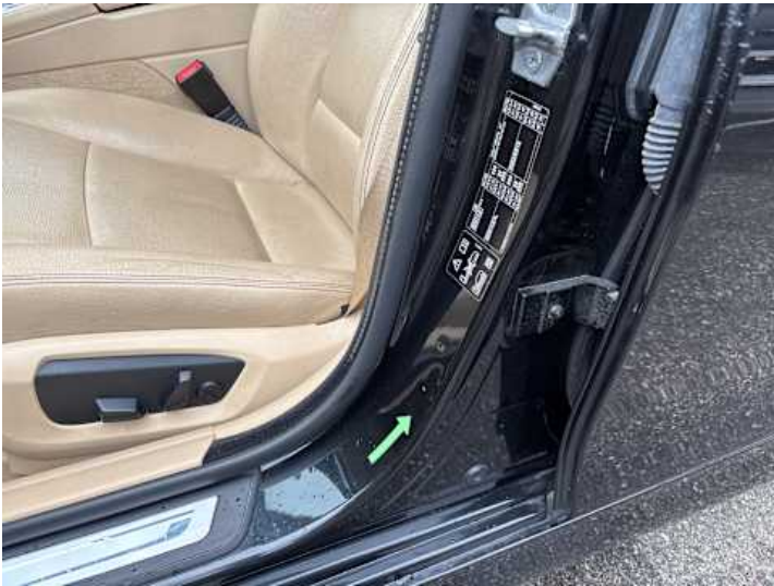
Schweller links (Delle, Kratzer)
