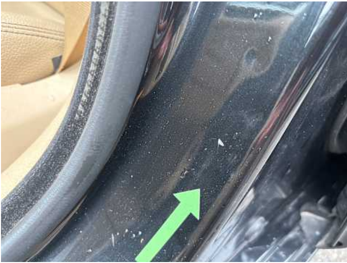
Schweller links (Delle, Kratzer)
