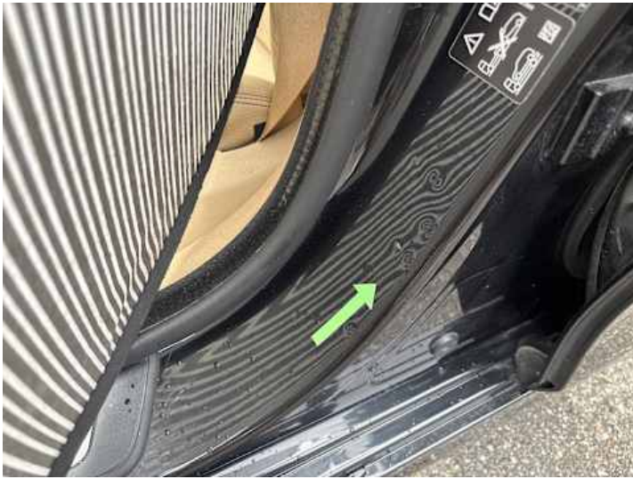
Schweller links (Delle, Kratzer)
