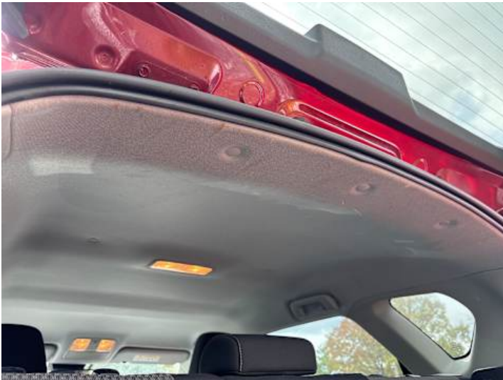
Innenraum (Diverse Schäden, Kratzer, Verschmutzung)
