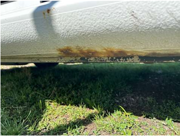
Schweller links (Rost)
