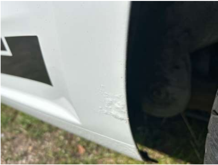
Seitenteil hinten links (Rost)
