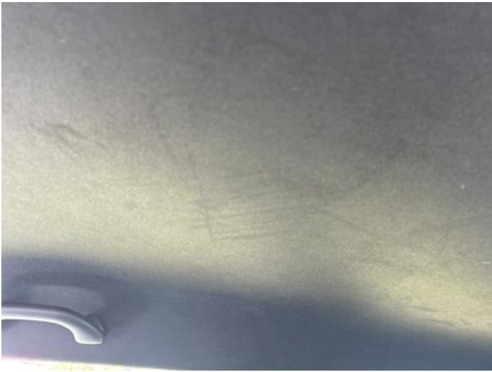
Innenraum (Kratzer, Diverse Schäden)
