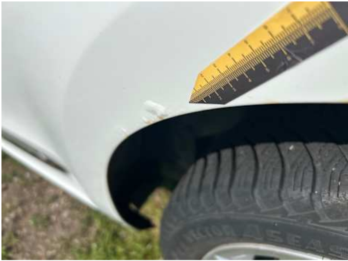
Seitenteil hinten links (Rost)
