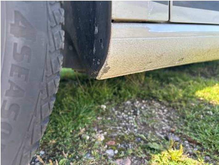
Schweller links (Rost)
