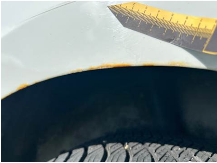
Seitenteil hinten links (Rost)
