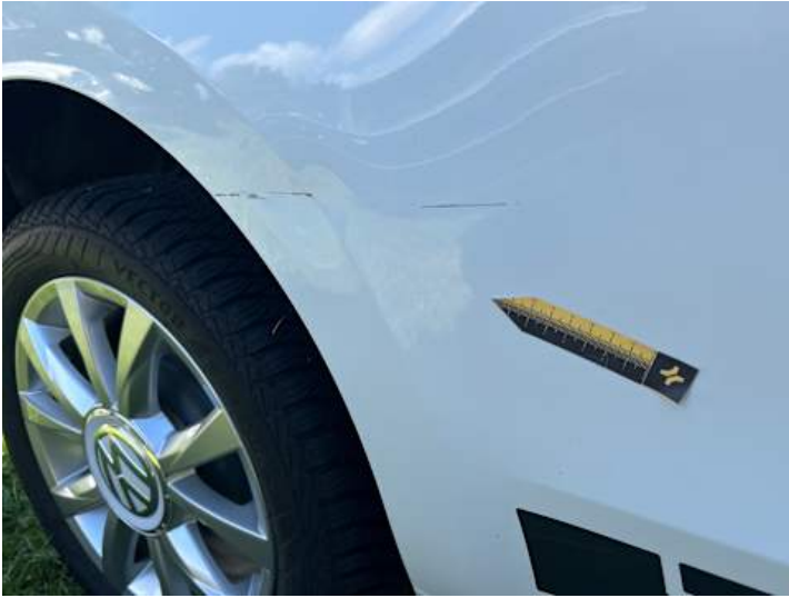
Seitenteil hinten rechts (Kratzer, Verformung)
