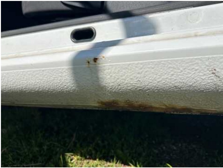
Schweller links (Rost)
