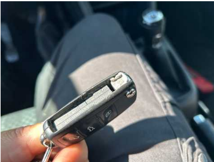
Innenraum (Anderer Schaden, Diverse Schäden): Schlüsselbart der Funkfernbedienung fehlt
