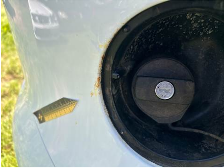
Seitenteil hinten rechts (Rost)
