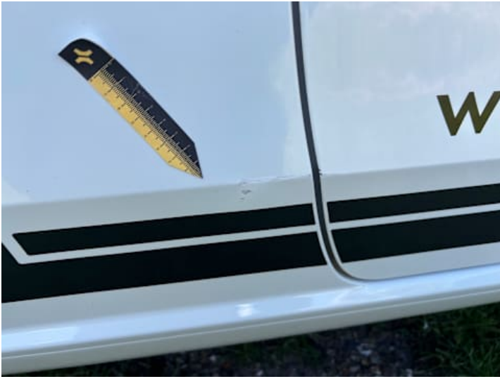
Seitenteil hinten rechts (Kratzer)
