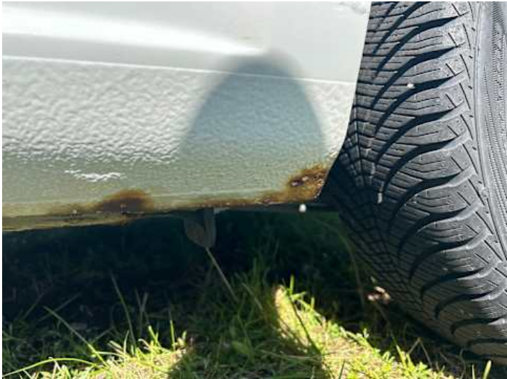
Schweller links (Rost)
